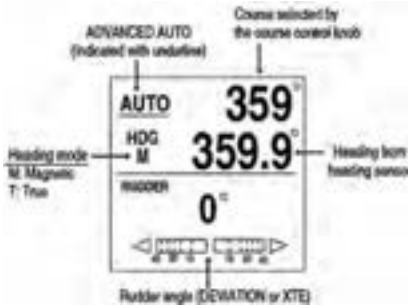
نمایشی از مد AUTO mode در سیستم اتوپایلوت AP500
