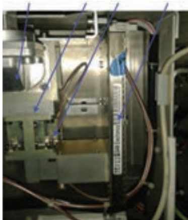
بخش FH محدودکننده فیلتر مایکروویو سیرکولاتور
