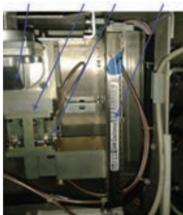
بخش FH محدودکننده فیلتر مایکروویو سیرکولاتور
