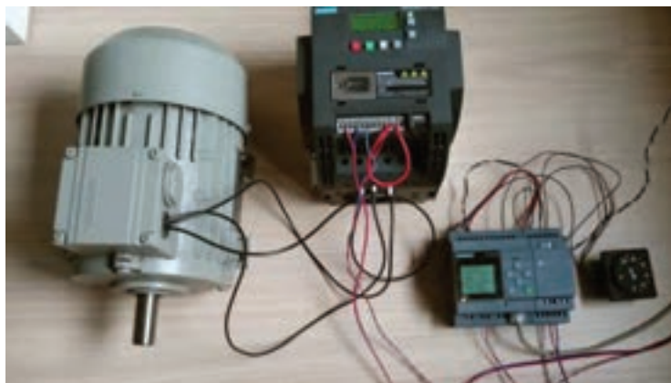
شکل ۲۱- راه اندازی موتور با Mini PLC
