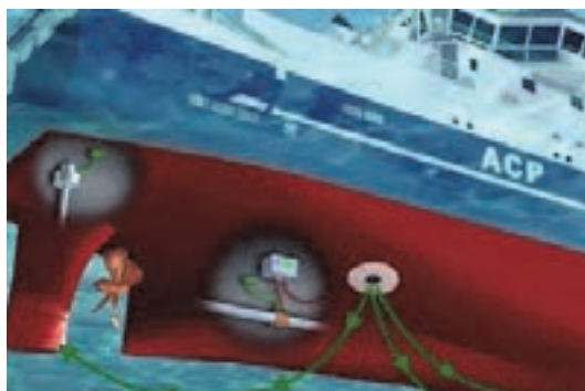
شکل ۳۱- بخش آندی و کاتدی بدنه شناور که در تماس با آب دریا می‌باشد
