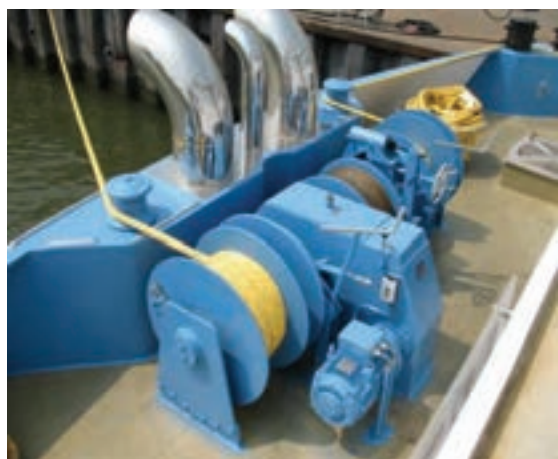
شکل ۸- سیستم Mooring شناور
