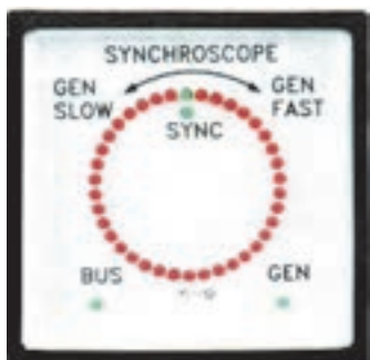
شکل ۱۳- سنکروسکوپ و مدار یک سنکروسکوپ ساده
