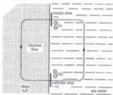
شکل ۳۱- بخش آندی و کاتدی بدنه شناور که در تماس با آب دریا می‌باشد
