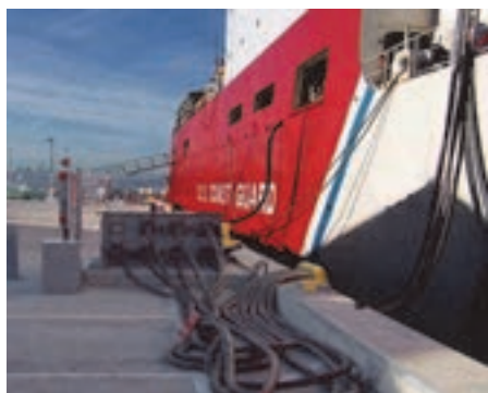
شکل ۲۰- استفاده از برق اسکله در زمان پهلوگیری شناور
