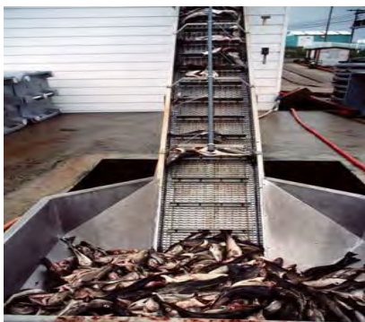
شکل ۱۶- کاربرد تسمه نقاله حمل ماهی در داخل شناور
