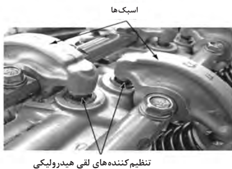
سرسیلندر دارای اسبک‌های تنظیم کننده هیدرولیکی
