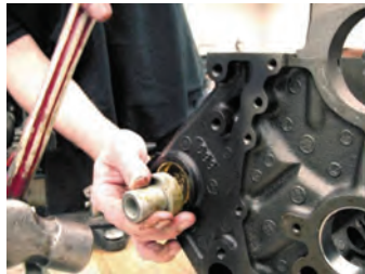
ابزار مخصوص و روش نصب پولکی
