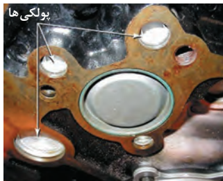
پولکی‌های نصب شده
