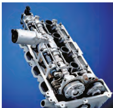
سرسیلندر با تجهیزات تایمینگ متغیر الکترومغناطیسی، ارتفاع متغیر باز کردن سوپاپ‌های ورودی
