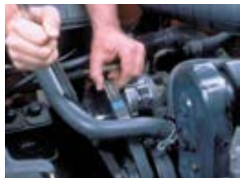
۶- تسمه سفت‌کن یا پایه آلترناتور شل شود.
