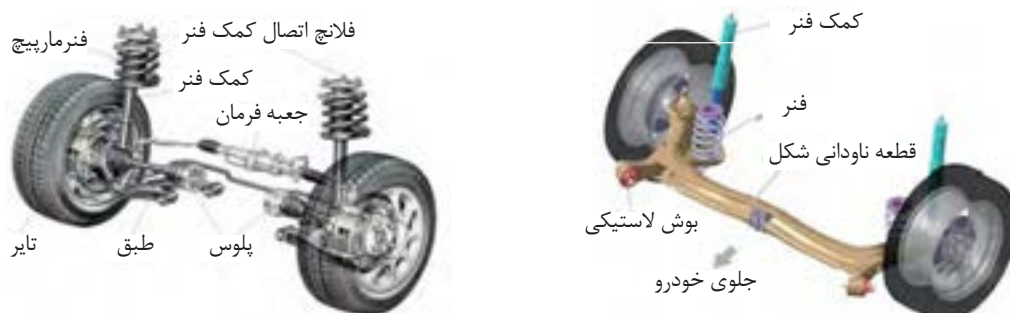
شکل ۳۶-۱- نمونه هایی از سیستم تعلیق و اجزای آن
