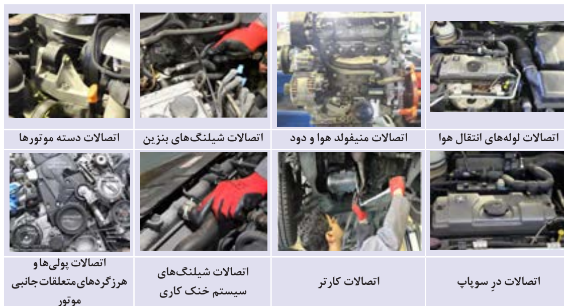
شکل ۱-۲۳ - بخش‌های مختلف سیستم مولد قدرت برای آچارکشی
