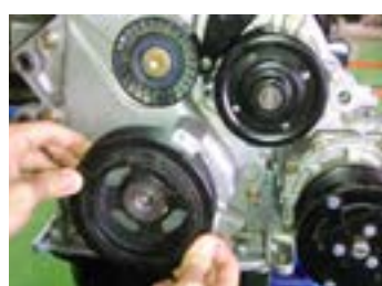
۱- پولی سرمیل‌لنگ و تسمه سفت‌کن نصب شود.
