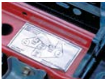
۴- به نحوه قرارگیری تسمه بر روی پولی‌ها و هرزگرد‌ها توجه شود.
