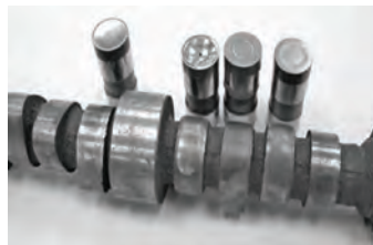
خوردگی تاپیپت و بادامک‌های میل سوپاپ
