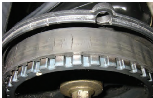
وجود ترک در محیط تسمه تایم نشانه نیاز به تعویض فوری تسمه است
