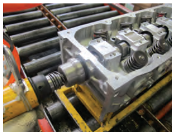
شکل ۱-۵۵ نحوه تعویض کاسه نمد میل سوپاپ با استفاده از ابزار مخصوص
