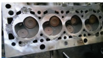
خوردگی سرسیلندر در ناحیه مجاری مایع خنک کننده
