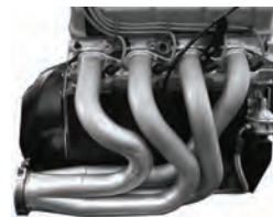
کنترل مانیفولد خروجی (فولادی)
