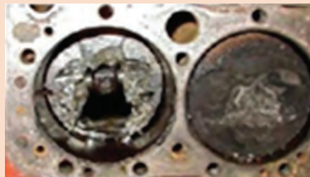
ذوب شدن پیستون
