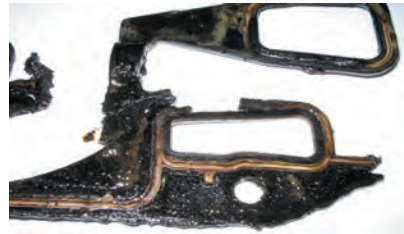
سوختن واشر آب بندی مانیفولد
