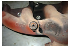
شکستگی مانیفولد خروجی (چدنی)
