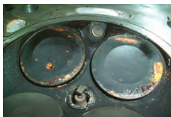
ورود آب به داخل سیلندر (مخلوط بودن آب با سوخت)
