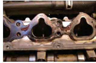
آثار نشتی مانیفولد دود روی سرسیلندر
