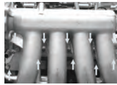
باز کردن پیچ‌های مانیفولد ورودی
