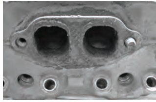
بریدن پیچ اتصال مانیفولد دود داخل سرسیلندر
