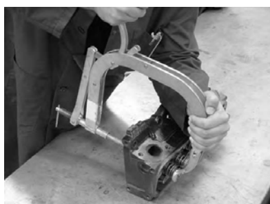
استفاده از فنر سوپاپ جمع کن دستی
