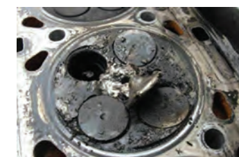
ذوب شدن سوپاپ
