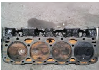
ورود مایع خنک کننده به سرسیلندر
