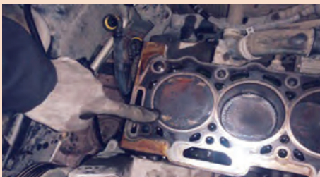
بر خورد سوپاپ‌ها به سر پیستون
