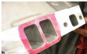
تابیدگی در مانیفولد ورودی
