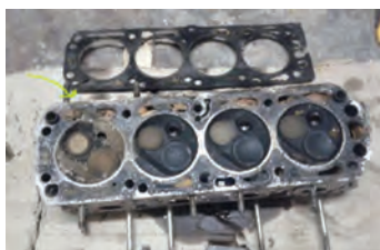
سوختن واشر سرسیلندر و ورود مایع خنک کننده به سیلندر ۱
