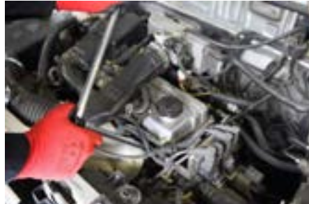
۱- شمع سیلندر مورد آزمایش باز شود و موقعیت تراکم برای پیستون ایجاد شود.
