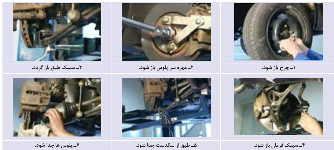
شکل ۹-۹- نحوه بازکردن پلوس
