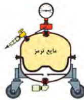
شکل ۱۶-۶- پر کردن و هواگیری سیستم هیدرولیک ترمز به وسیله دستگاه تزریق تحت فشار
