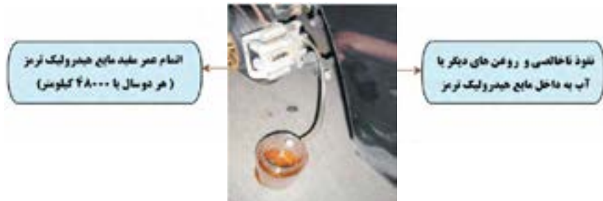
شکل ۹-۶- لزوم تخلیه کامل روغن هیدرولیک ترمز
