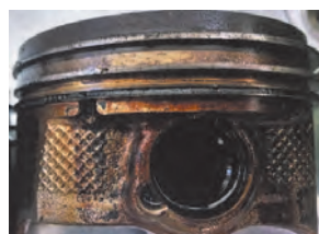
ب) کربن گرفتگی بیش از حد رینگ ها
