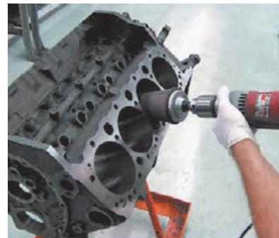
اصلاح لبه پله شده سیلندر با سنگ مخصوص
