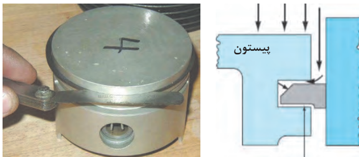
ب) کنترل خلاصی رینگ و پیستون نو
