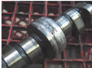
خرابی تکیه‌گاه میل سوپاپ شکل ۱۶-۲
