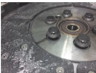
ب) شل شدن پیچ‌های فلاپیول
