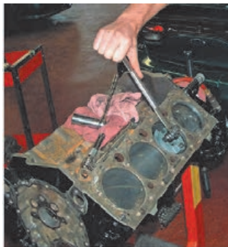
اصلاح لبه پله شده سیلندر با ابزار مخصوص
