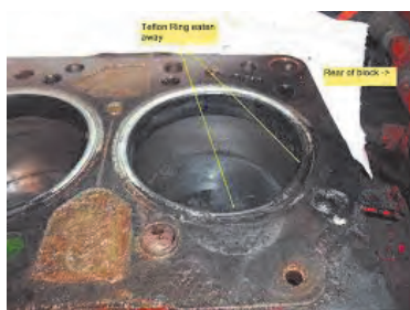
نشستی از محل های مختلف بوش سیلندر و واشر سرسیلندر و بالای بوش
