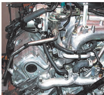
محل نصب EGR روی موتور خودرو
