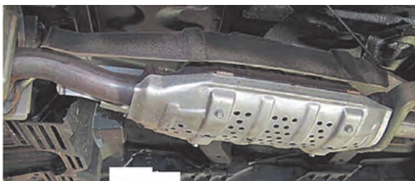
شکل ۲۷-۳ محل نصب سپر حرارتی در سیستم اگزوز
