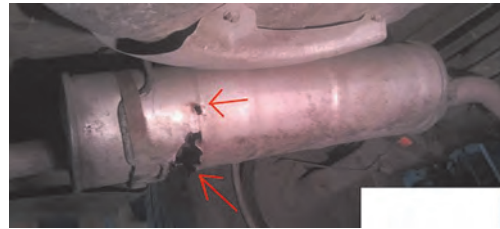
مشاهده و کنترل سیستم از نظر نشتی دود
