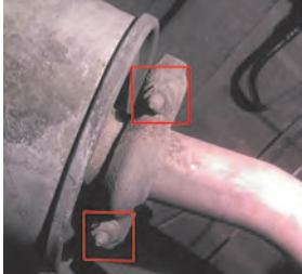
کنترل اتصالات لوله از صدا خفه کن
