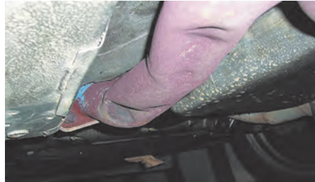
کنترل و مشاهده لوله اگزوز از نظر خم شدن و تغییر شکل دادن
