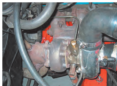
محل نصب توربو شارژر روی موتور
