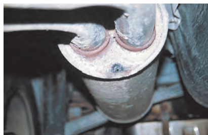
تصویر سوراخ شدن کاتالیست
