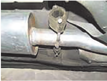
بررسی بست‌های نگهدارنده سیستم اگزوز
