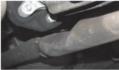
کنترل و مشاهده لوله اگزوز از نظر خم شدن و تغییر شکل دادن
