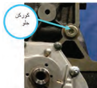
نصب پیچ‌های گورکن روی بلوک
