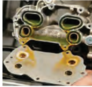
نصب درپوش خنک کن روغن
