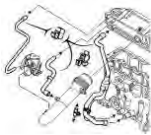
نصب لوله ها و شیلنگ های بخارات روغن
