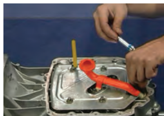
باز کردن صافی روغن ورودی به پمپ
