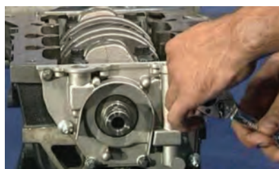
باز کردن پیچ های پمپ روغن
