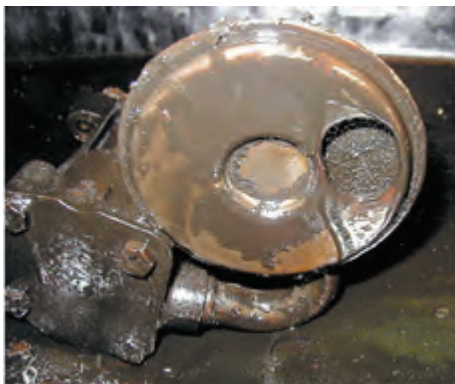
شکل ۴-۲۷ صافی پمپ روغن جرم گرفته
