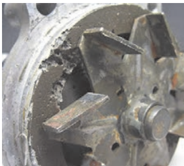
خرابی بلبرینگ و خوردگی داخلی
