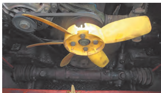
وجود شکستگی یا ترک پره‌ها
