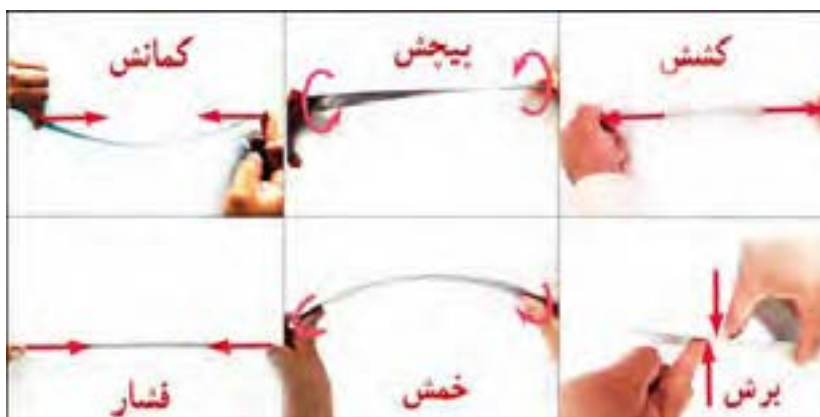
شکل ۴-۶- انواع بارگذاری روی خط کش فلزی
