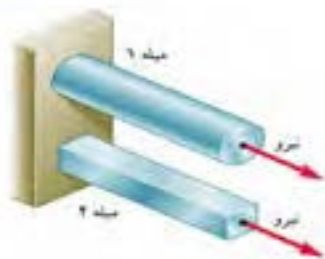
شکل ۱۶-۶- بارگذاری یکسان بر روی میله‌هایی با طول و جنس و وزن یکسان
