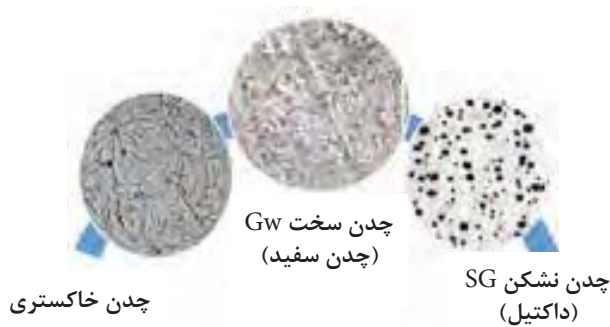
شکل ۱۹-۴- انواع چدن و شکل متالوگرافی آنها
