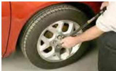
شکل ۴-۵- گشتاور لازم برای سفت کردن چرخ
