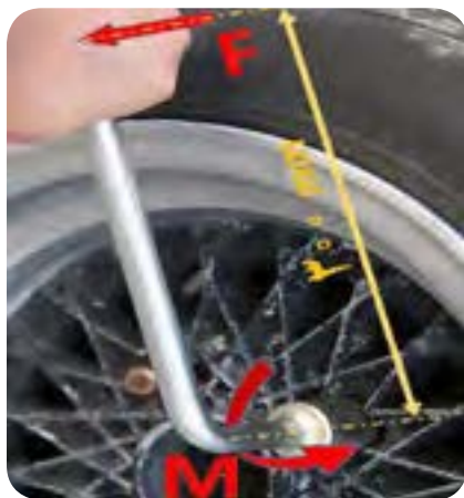
شکل ۱۰-۶- باز کردن پیچ چرخ خودرو توسط آچار چرخ
