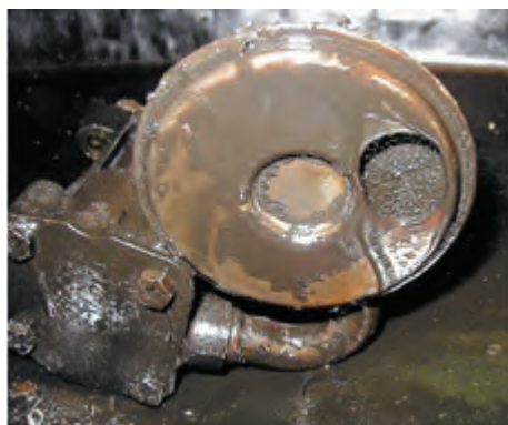
شکل ۴-۲۷ صافی پمپ روغن جرم گرفته
