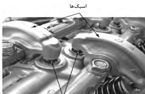
تنظیم کننده های لقی هیدرولیکی
