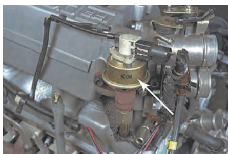
محل نصب EGR روی موتور خودرو
