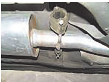
بررسی بست‌های نگهدارنده سیستم اگزوز
