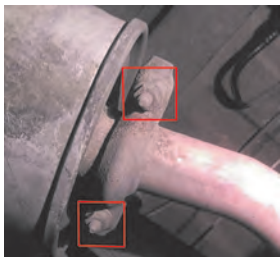
کنترل اتصالات لوله از صدا خفه کن
