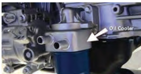
شکل ۸-۴ خنک کن روغن موتور
