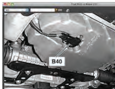
شکل ۱۰-۴ حسگرهای سطح و دمای روغن موتور
