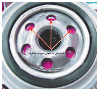
سوپاپ یک طرفه روغن
