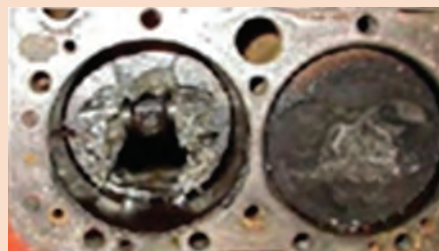
ذوب شدن پیستون
