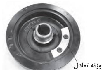
الف) اتصال وزنه بر روی پولی جهت بالانس شکل ۸۵-۲ ب) چسباندن وزنه بر روی صفحه ارتجاعی جهت بالانس (فلاپیول)
