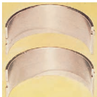
الف) سایش غیر یکنواخت یاتاقان
