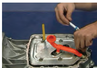
باز کردن صافی روغن ورودی به پمپ
