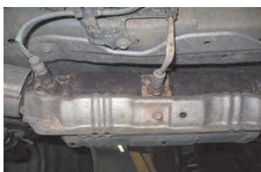
محل نصب حسگر اکسیژن روی مبدل کاتالیست
