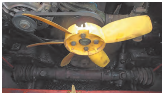
وجود شکستگی یا ترک پره ها
