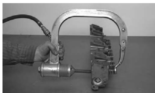
استفاده از فنر سوپاپ جمع کن پنوماتیکی
