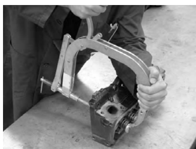
استفاده از فنر سوپاپ جمع کن دستی
