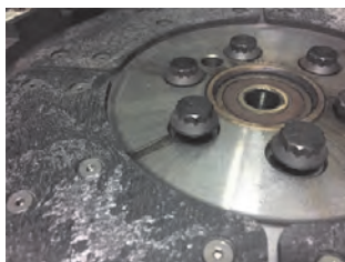
ب) شل شدن پیچ‌های فلاپیول
