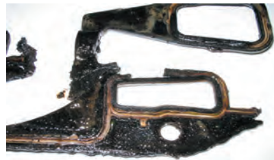
سوختن واشر آب بندی مانیفولد
