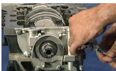
باز کردن پیچ های پمپ روغن
