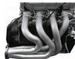
کنترل مانیفولد خروجی (فولادی)
