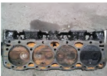
ورود مایع خنک‌کننده به سرسیلندر
