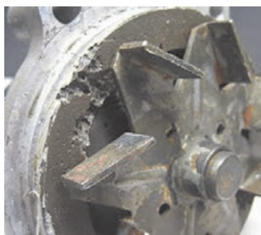
خرابی بلبرینگ و خوردگی داخلی
