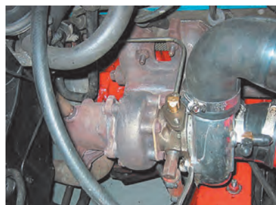
محل نصب توربو شارژر روی موتور
