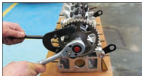
مراحل باز کردن چرخ تسمه
