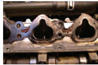
آثار نشتی مانیفولد دود روی سرسیلندر
