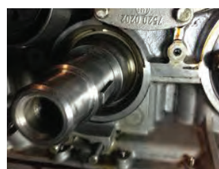
بازکردن چرخ دنده سر میل لنگ
