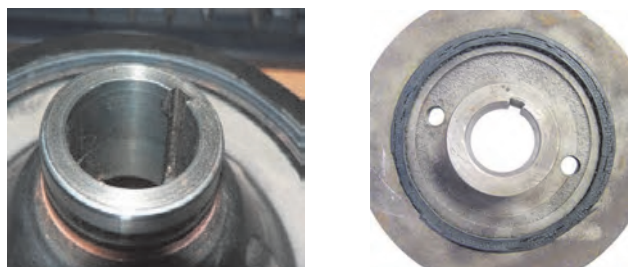
ساییده شدن محل قرارگیری کاسه نمد
