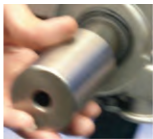
نصب کاسه نمدها با ابزار مخصوص
