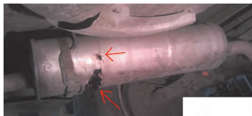
مشاهده و کنترل سیستم از نظر نشتی دود
