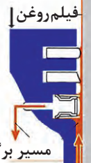
الف) رینگ روغن سه تکه شکل ۲-۵۸ ب) برگشت روغن به کارتر توسط رینگ روغن
