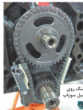
مکانیزم حرکتی زنجیری در موتور OHV
