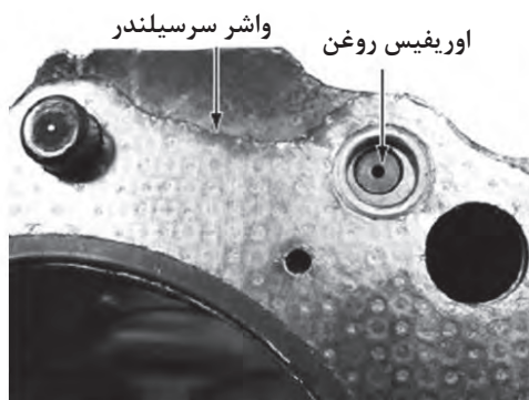
شکل ۱۲-۴ اوریفیس مدار روغن کاری
