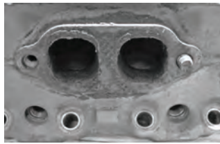
بریدن پیچ اتصال مانیفولد دود داخل سرسیلندر
