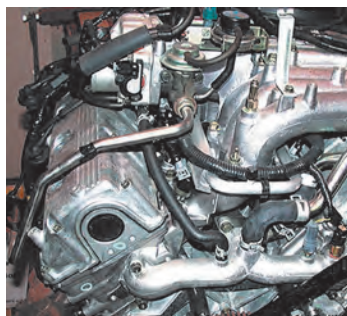
محل نصب EGR روی موتور خودرو
