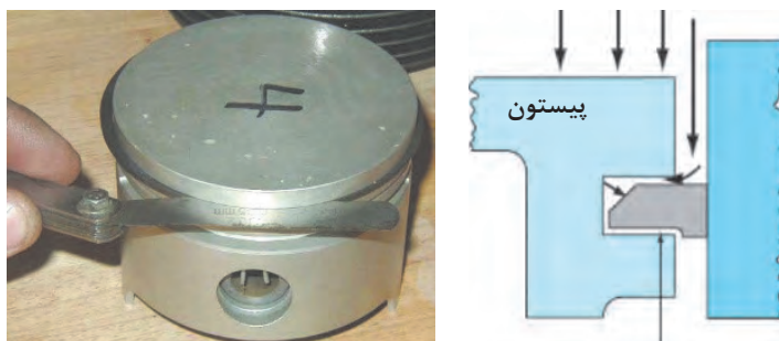
الف) ساییدگی رینگ ب) کنترل خلاصی رینگ و پیستون نو شکل ۱۴۱-۲
