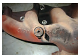
شکستگی مانیفولد خروجی (چدنی)
