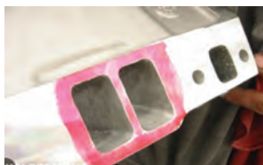
تابیدگی در مانیفولد ورودی
