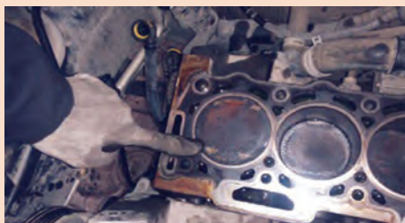
برخورد سوپاپ‌ها به سر پیستون
