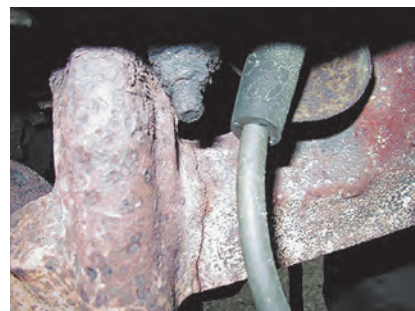
تصویر شکستگی مانیفولد
