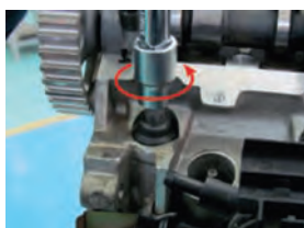
جهت باز کردن پیچ های سرسیلندر
