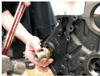
ابزار مخصوص و روش نصب پولکی
