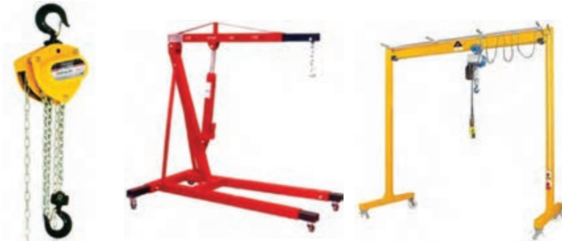
شکل ۲۹- وسایل حمل کارگاهی تجهیزات تأسیساتی
