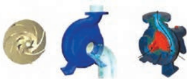
شکل ۱۰- مسیر جریان مایع در پمپ گریز از مرکز
