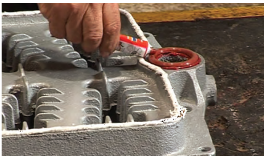
شکل ۲۰- استفاده از اورینگ به جای بوش
