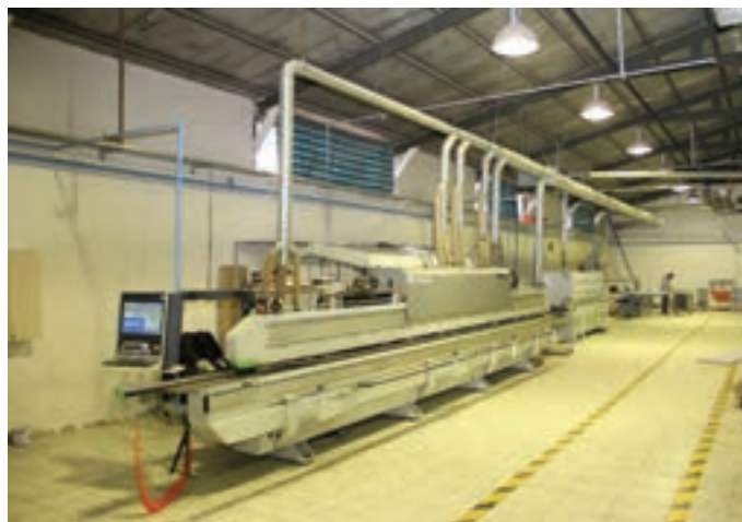
شکل ۱۱- نحوه اتصال مکنده‌های ثابت
