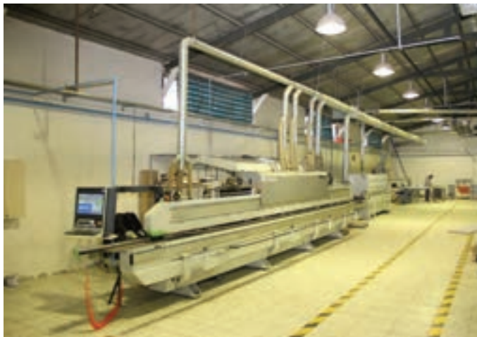
شکل ۱۱- نحوه اتصال مکنده‌های ثابت
