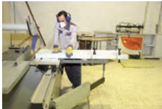
شکل ۷۵- برش توسط دستگاه پانل بر
