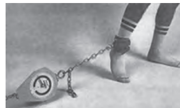
شکل ۱-۲ کابل تنسیومتر
