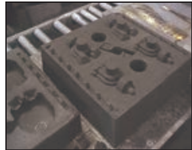
شکل ۱- ریخته‌گری در قالب‌های ماسه‌ای (موقت)
