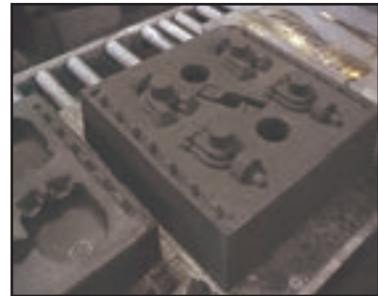
شکل ۱- ریخته‌گری در قالب‌های ماسه‌ای (موقت)
