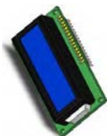
LCD کاراکتری برای نمایش اطلاعاتی مانند فاصله
