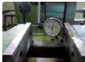
تنظیم گیره به کمک ساعت اندازه گیری
