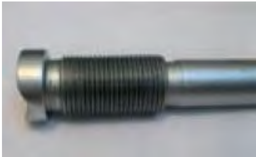
شکل ۲-۳۴: نمونه کار شیار تراشی
