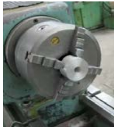
ب: بستن قطعه گرد در چهار نظام
