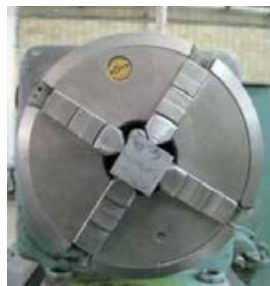
ب: بستن قطعه با مقطع مربع در چهار نظام
