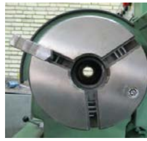
الف: استقرار فک روی پیچ ارشمیدس
