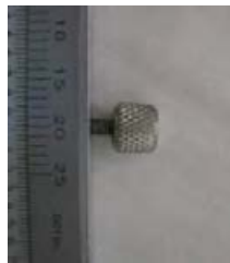
شکل ۲-۴۱: نمونه کار آج‌زنی
