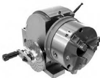
شکل ۳-۸: انواع وسایل بستن قطعه کار در فرزکاری
