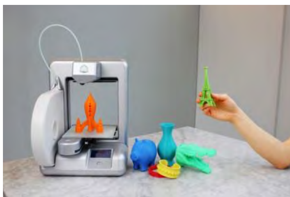
ب: قطعات ساخته‌شده به روش لایه‌نشانی مذاب
