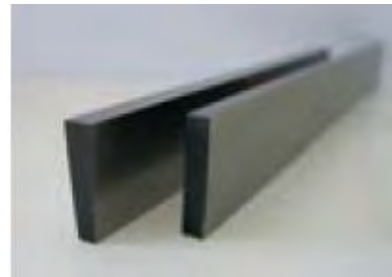
شکل ۲-۳۵: رنده شیار تراشی
