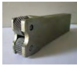
شکل ۲-۴۳: انواع نگه‌دارنده قرقره آج‌زنی
