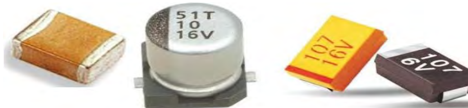
چند نمونه خازن نصب سطحی
