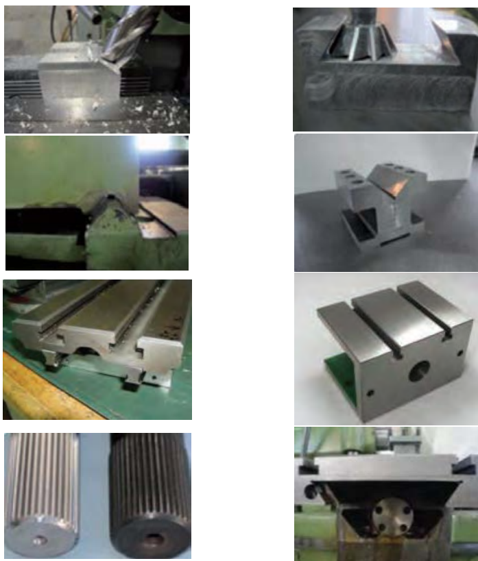
شکل ۳-۱۶: نمونه‌هایی از سطوح زاویه‌ای و شیارهای متنوع
