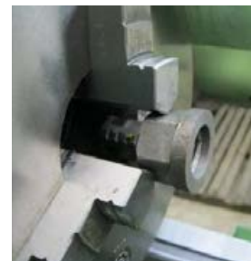
الف: بستن قطعه شش گوش در سه نظام
