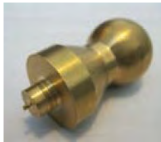
شکل ۲-۳۹: نمونه کار شیار و برش
