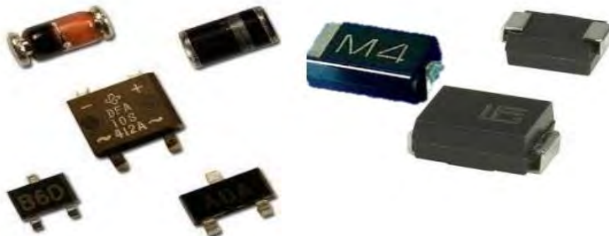
چند نمونه دیود نصب سطحی
