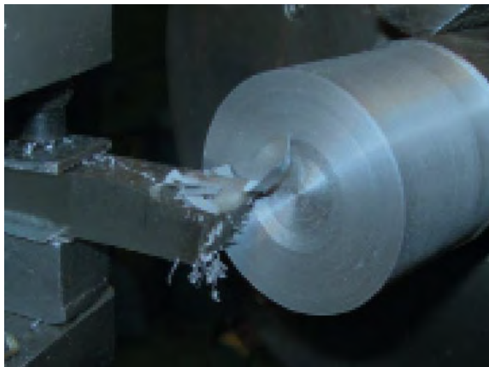
شکل ۲-۲۹: تراشکاری قطعات کوتاه
