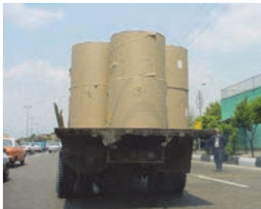
شکل ۳۷- نمونه‌ای از حمل نادرست رل‌های کاغذ
