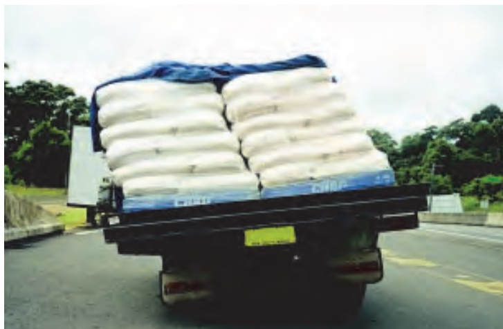
شکل ۳۲- عدم تعادل وسیله‌نقلیه به دلیل بارگیری نامناسب
