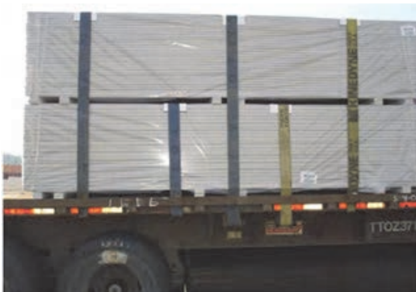
شکل ۴۹- نحوه چیدن ردیف‌های باندل روی هم
