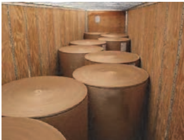
شکل ۳۶- نمونه‌ای از مهر رل‌های کاغذ با کمک دیواره‌های بارگیر
