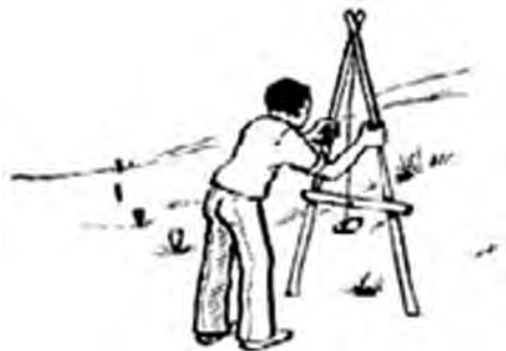
طرز استفاده از قاب مخصوص رسم خطوط تراز
