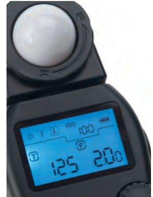
تصویر ۱۹۳ سنجش نور فلاش با اتصال سیم سینکرون
