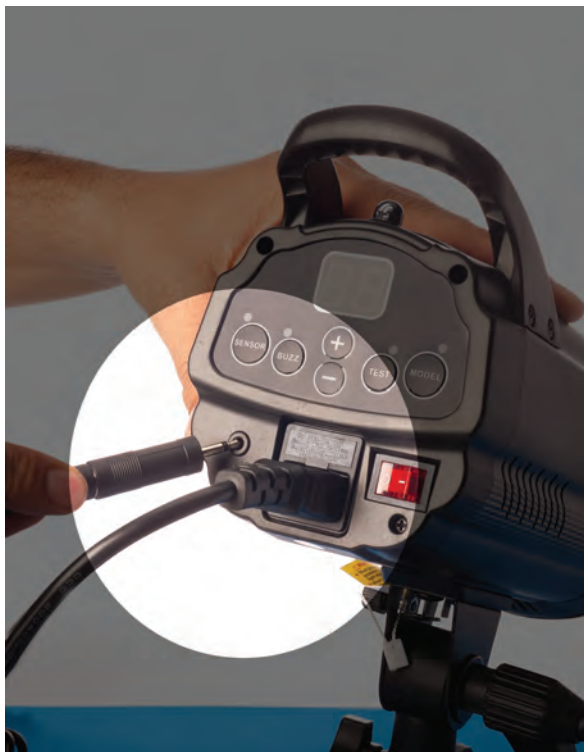
▲ اتصال سیم سینکرون رادیوتریگر به فلاش | تصویر ۱۳۶
