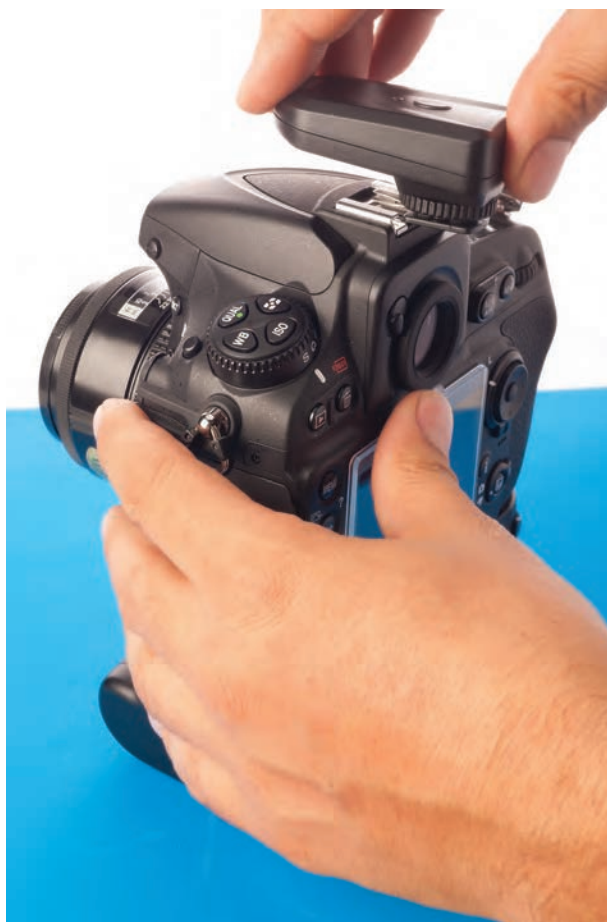
▲ اتصال ريموت فرستنده به دوربین | تصویر ۱۳۵
