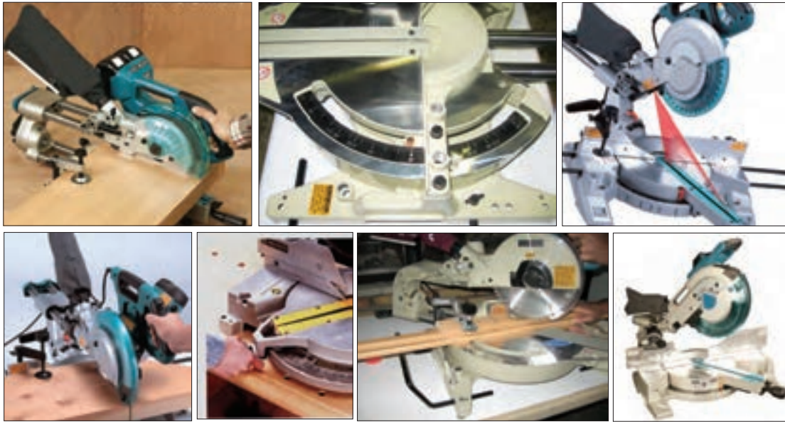
شکل ۵۸ تا ۶۴ - بخش های مختلف ماشین اره گرد فارسی بر از زوایای مختلف
