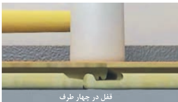
شکل ۴۴ - اتصال فاق و زبانه قطعات لمینت به یکدیگر
