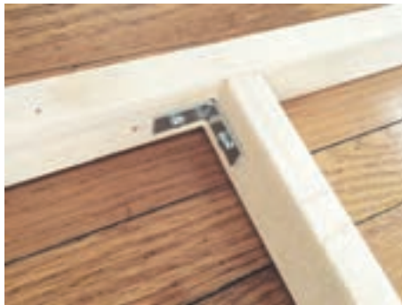
شکل ۲۱- اتصال با بست گونیایی
