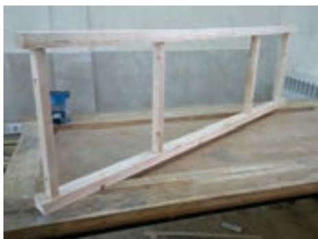
شکل ۵۲- اتصال موقت قطعات پاروان
