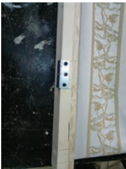
شکل ۷۲- محکم کردن برگه اول لولا با ۳ پیچ
