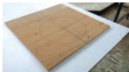
شکل ۳۷- ترسیم دایره بر روی تخته چندلایه
