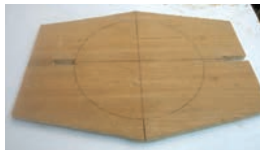
شکل ۶۰- شکاف پایه‌ها به صورت برش خورده
