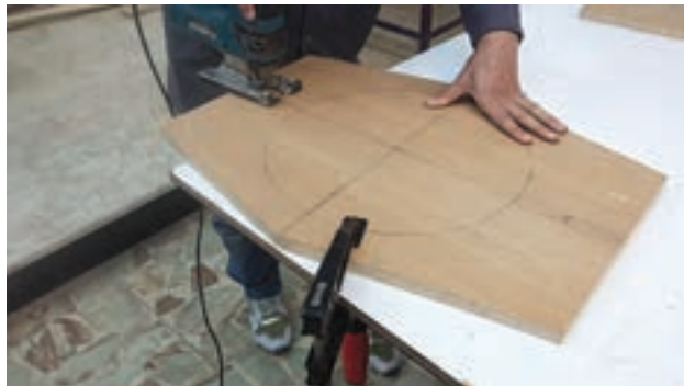
شکل ۴۹- محکم بستن قطعه کار
