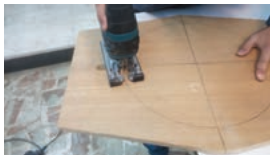
شکل ۶۱- برش کفی دایره شکل
