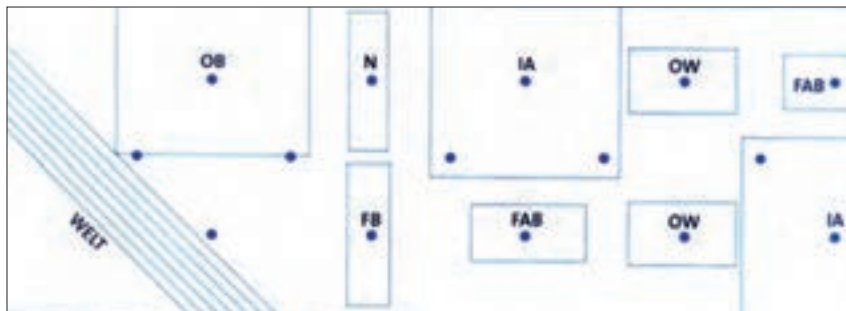
شکل ۷۷- نمونه ای از چیدمان قسمت‌های مختلف یک مبلی برای برش پارچه روی مبلی
