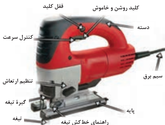
شکل ۴۰- قسمت‌های مختلف اره عمودبر
