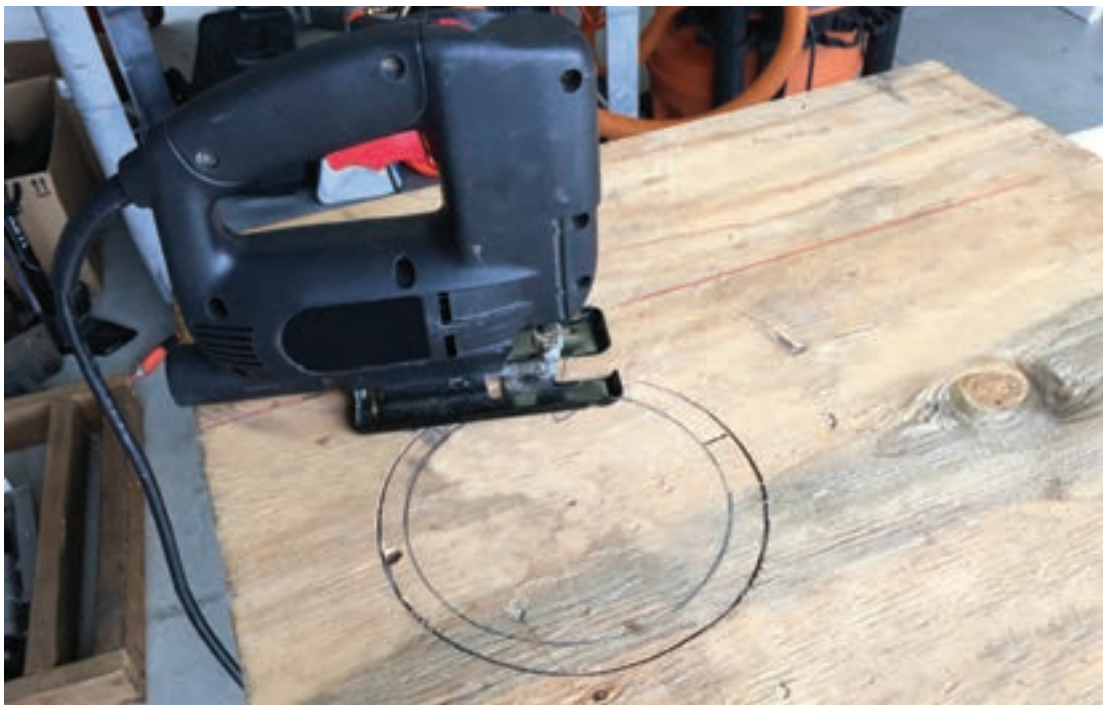
شکل ۵۱- برش داخل قطعه کار
