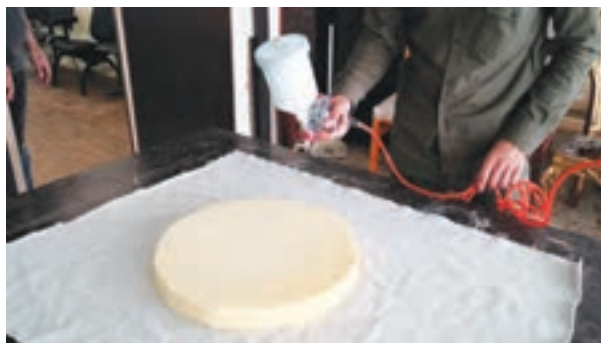
شکل ۸۷- پاشیدن چسب با پیستوله
