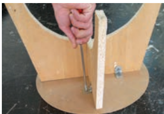
شکل ۶۷- مراحل مونتاژ چهارپایه
