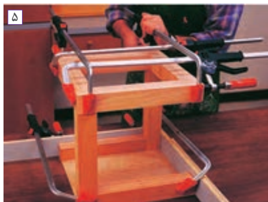
شکل ۲۷- مراحل مونتاژ میز جلوی مبل
