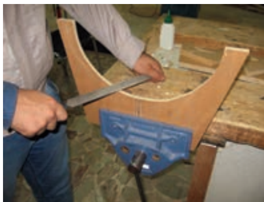
شکل ۶۳- پرداخت با چوبسای زبر
