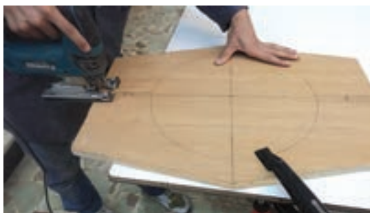
شکل ۵۷- برش شکاف وسط پایه‌ها
