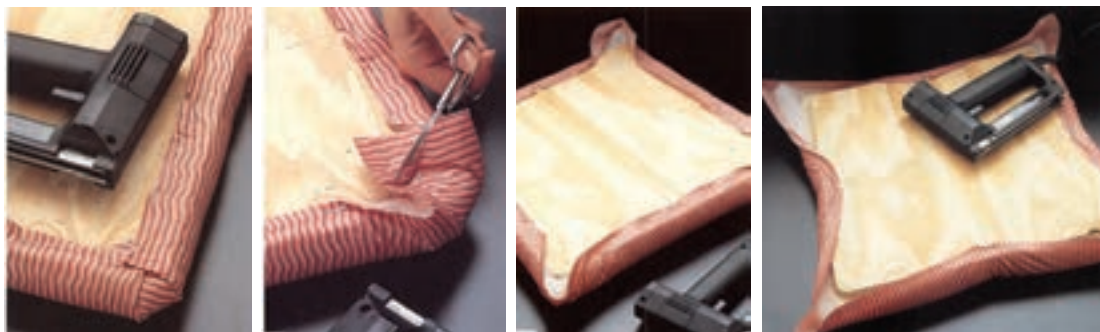
شکل ۸۸- ثابت کردن پارچه شکل ۸۹- کوبیدن پارچه شکل ۹۰- قیچی کردن گوشه ها شکل ۹۱- گوشه های منگنه خورده
