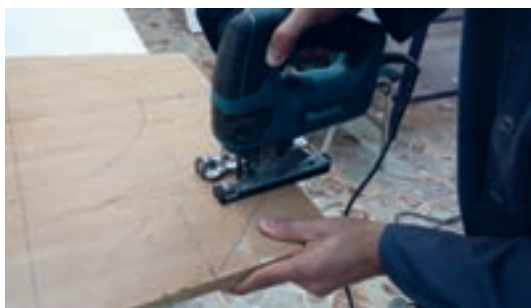
شکل ۵۴- بریدن قطعه کناری تشکیل دهنده نبشی‌ها
