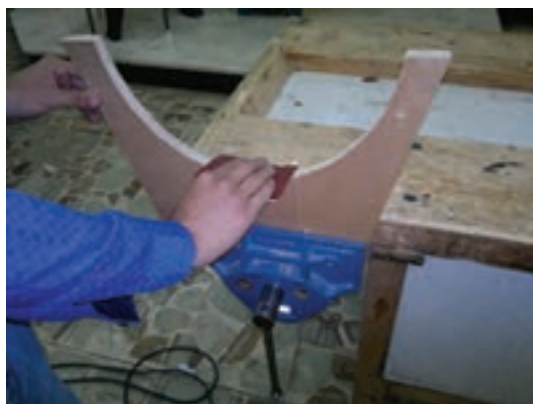
شکل ۶۵- سنباده کاری با دست
