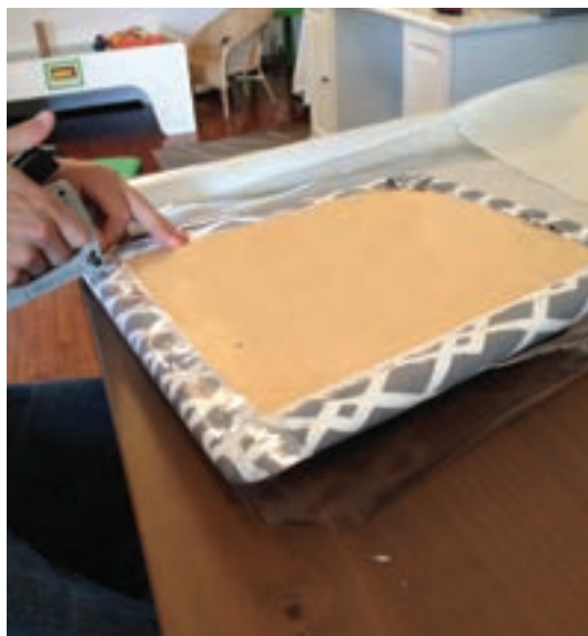
شکل ۷۸- رویه کوبی روی تخته
