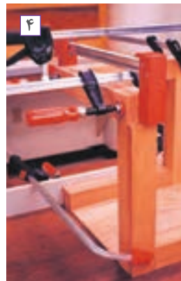
شکل ۲۷- مراحل مونتاژ میز جلوی مبل
