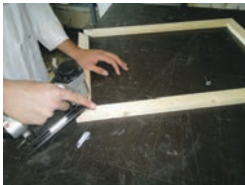
شکل ۲۷-منگنه زدن گوشه‌های دیگر قاب
