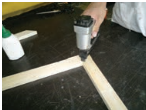
شکل ۲۵-قرار دادن دو قطعه در کنار هم برای منگنه زدن
