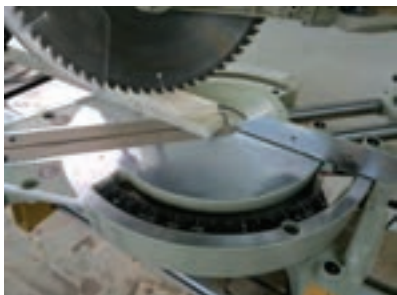
شکل ۲۱- بریدن یک قطعه هم اندازه قطعه دیگر
