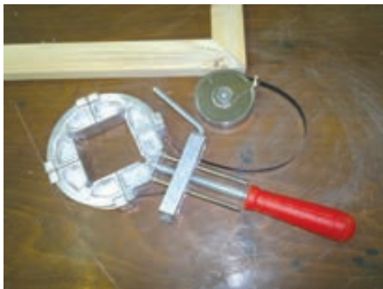
شکل ۲۹- گیره تسمه‌ای مخصوص قاب
