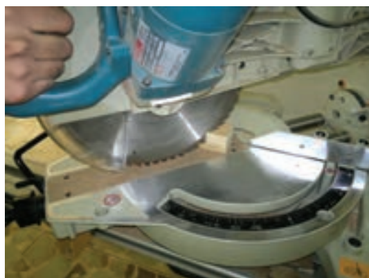
شکل ۲۲- بریدن دو قطعه با هم
