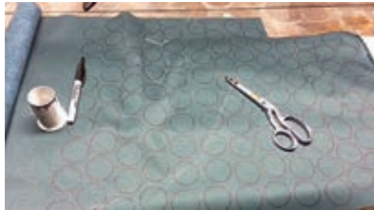
شکل ۶۴- خط‌کشی برای دکمه روی چرم مصنوعی
