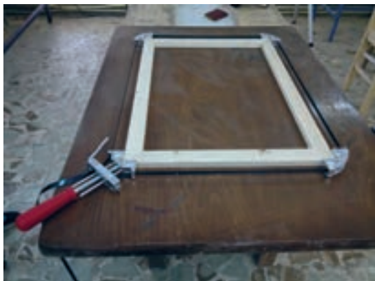
شکل ۳۰- بستن قاب با استفاده از گیره تسمه‌ای
