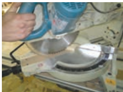
شکل ۲۰- برش فارسی یا ۴۵ درجه باره فارسی بر
