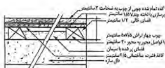
اجرای کف پوش چوبی
