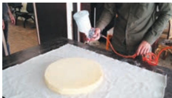
شکل ۸۷- پاشیدن چسب با پیستوله
