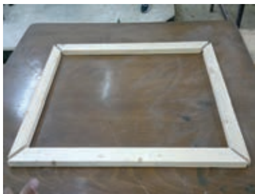
شکل ۲۳-قطعات قاب، برش فارسی خورده و آماده شده
