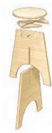
شکل ۳۰- نقشه انفجاری چهارپایه
