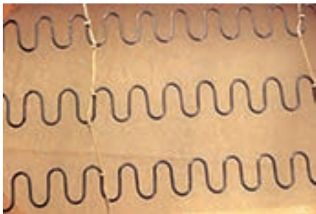
شکل ۷۴ - فنر زیگزاگ (سینوسی)
