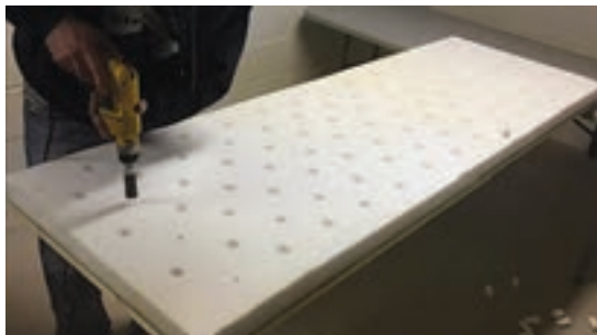
شکل ۵۸- سوراخ کاری اسفنج با متۀ گردبر
