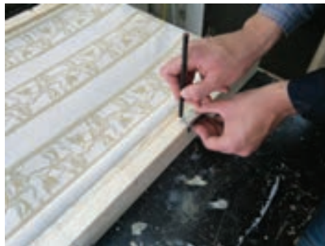
شکل ۶۸- خط کشی با استفاده از لولا
