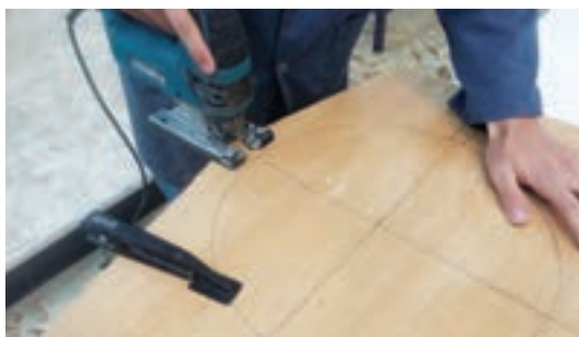
شکل ۵۶- برشکاری از محل اتصال پایه‌ها
