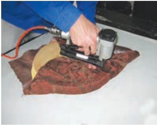
شکل ۱۱۷- منگنه زدن چهارطرف و ثابت کردن پارچه
