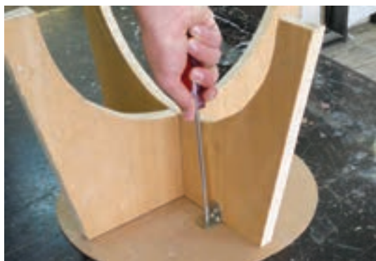
شکل ۶۷- مراحل مونتاژ چهارپایه
