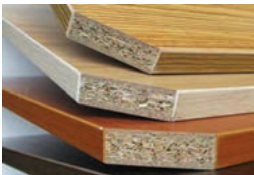
شکل ۱۴- تخته خرده چوب با روکش مصنوعی
