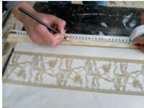
شکل ۶۶- اندازه گیری محل لولا
