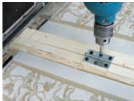
شکل ۷۶- بستن کامل پیچها
