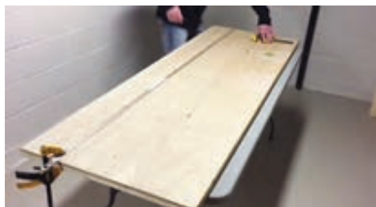
شکل ۴۶- بستن خط کش با گیره
