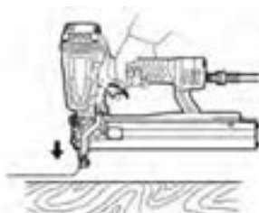
شکل ۱۰۵- قرار دادن دستگاه منگنه بر روی قطعه کار
