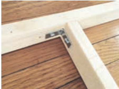
شکل ۲۱- اتصال با بست گونیایی
