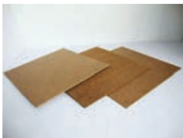
شکل ۹- تخته فیبر بدون روکش
