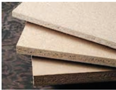
شکل ۱۳- تخته خرده چوب بدون روکش
