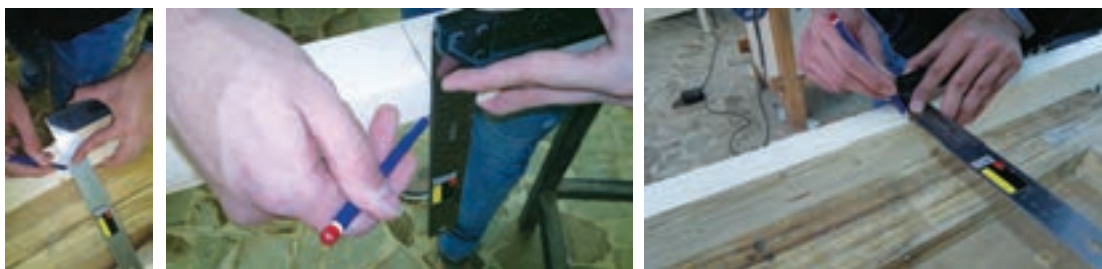
شکل ۴۵- انتقال اندازه‌ها به قطعه دوم
