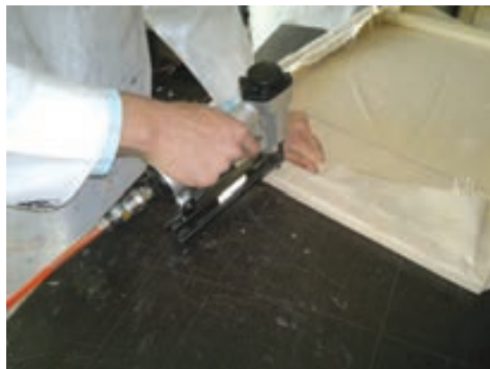
شکل ۳۷- منگنه زدن ضلع آخر قاب
