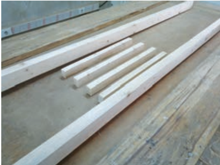
شکل ۳۹- قطعات پاراوان (۲ قید طولی و ۴ قید عرضی)
