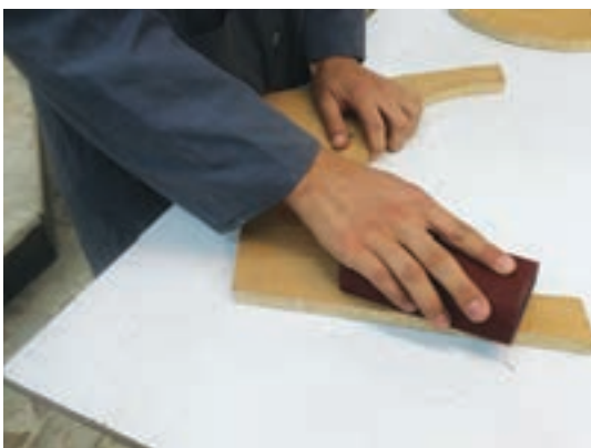
شکل ۶۶- پرداخت کاری با تخته سنباده
