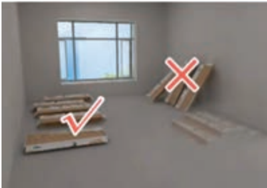
شکل ۲۸ و ۲۹- نحوه قرار دادن درست جعبه های لمینت
