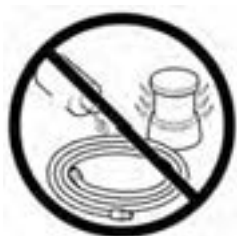
شکل ۱۰۹- محافظت شیلنگ هوا در مقابل شعله، بخاری و مواد شیمیایی
