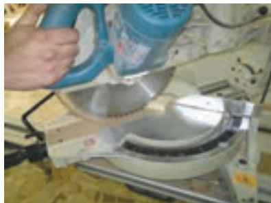
شکل ۲۰- برش فارسی یا ۴۵ درجه با اره فارسی بر
