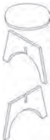
شکل ۳۰- نقشه انفجاری چهارپایه
