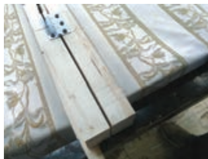
شکل ۷۴- بستن پیچ دوم برگه دوم لولا
