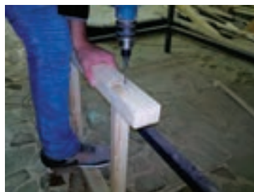
شکل ۵۳- سوراخ کاری با مته خزینه دار
