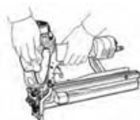
شکل ۱۰۸- پاک کردن دستگاه با دستمال روغنی
