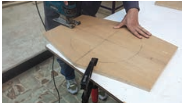
شکل ۴۹- محکم بستن قطعه کار
