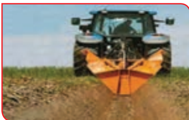
ساختن جوی های آبیاری
