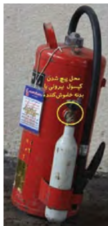
شکل ۹-۳ خاموش کننده پودر و گاز فشنگ خارج
