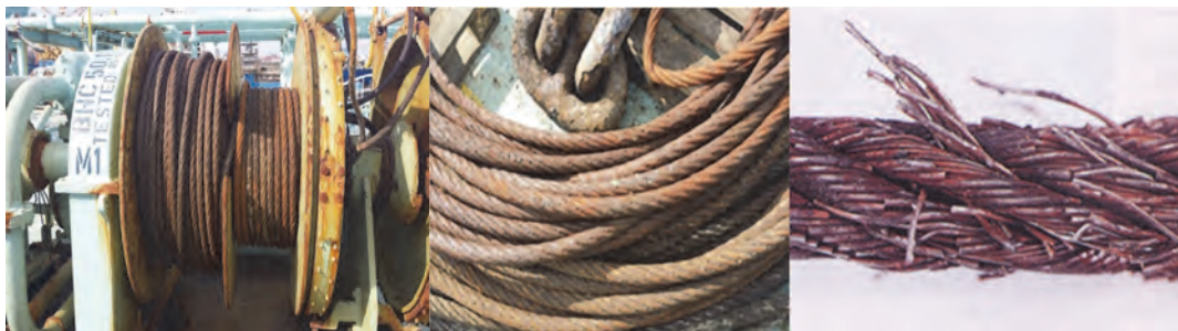
شکل ۱۶-۱ نمونه‌هایی از عدم نگهداری صحیح ماشین‌آلات
