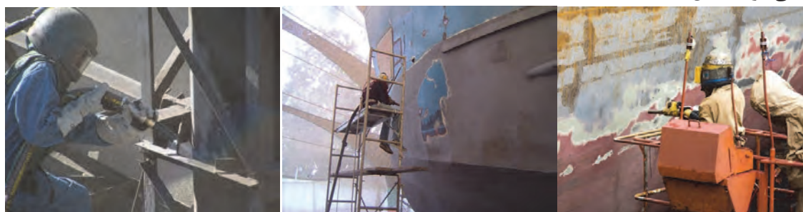
شکل ۱-۷ زنگ‌زدایی در اسکله خشک
