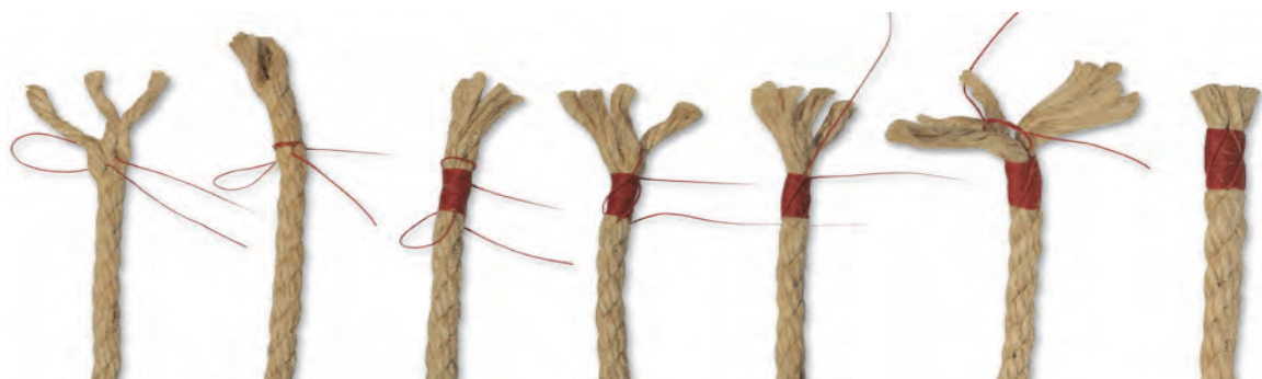
شکل ۲-۲۱- نخ‌پیچی کردن انتهای طناب
