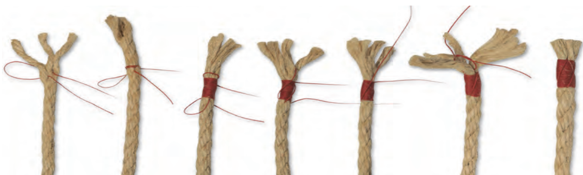
شکل ۲۱-۲- نخ‌پیچی کردن انتهای طناب
