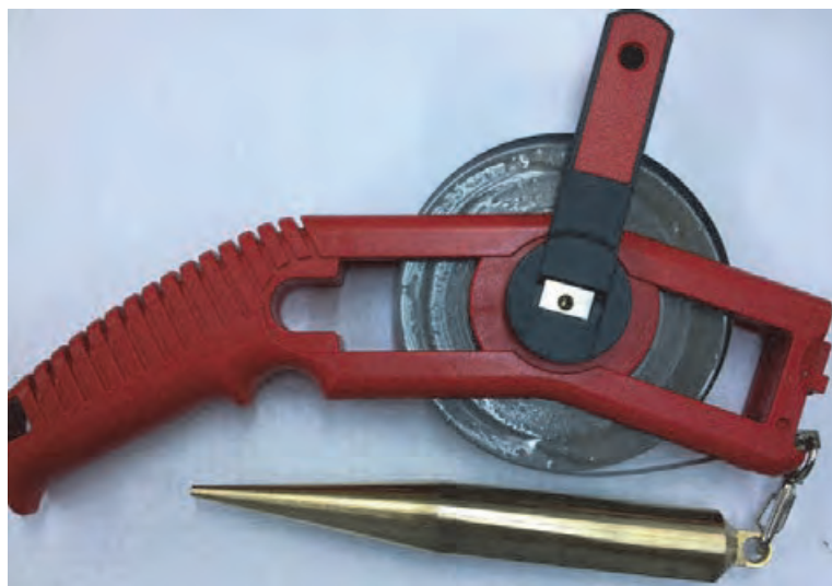
شکل ۳-۶- Sounding tape برای اندازه‌گیری سطح مخزن
