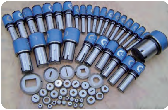
نمونه های سنبه‌های دستگاه پانچ CNC
