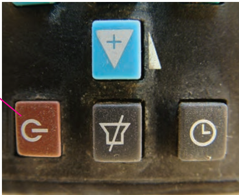
شکل ۱-۱۸۵ ارسال فرمان آماده به کار با کنترل از راه دور
