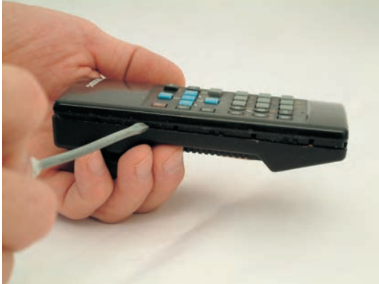
شکل ۳-۴۶- نحوه بازکردن قاب پشت کنترل از راه دور
