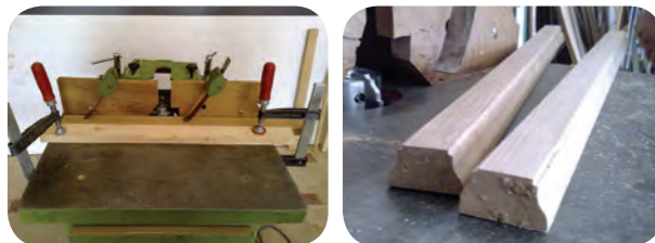
شکل ۲-۳۰- چوب ابزار خورده، ابزار زدن قطعه کار
