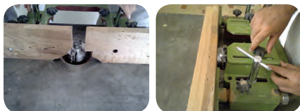
شکل ۲۹-۲- الف- بستن حفاظ‌ها
