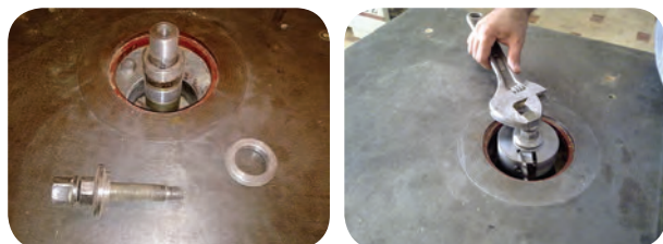
شکل ۲۸-۲- تنظیم کردن تویی در دستگاه فرز
