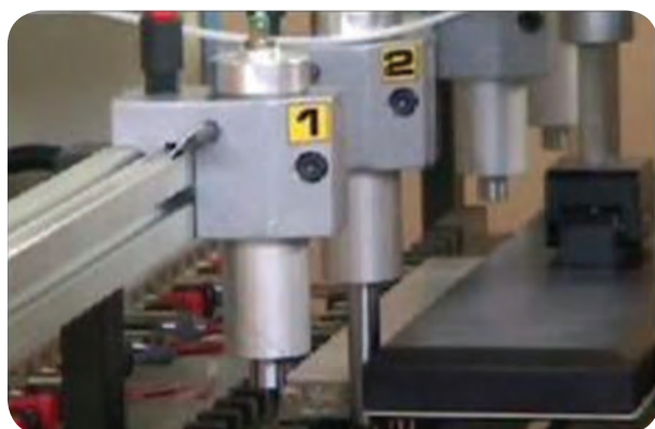
شکل ۳-۷ - قطعه کار، توسط جک‌ها گونیا شده است.
