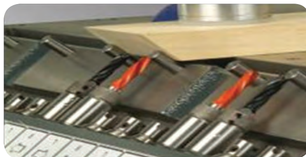
شکل ۳-۵ - سوراخ کاری قطعات زاویه دار
