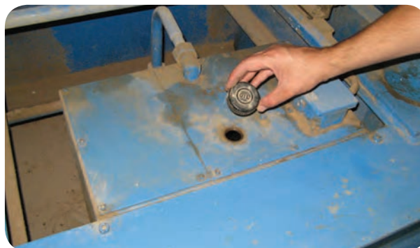
شکل ۸۸-۵- کنترل و تعویض روغن هیدرولیک مخزن
