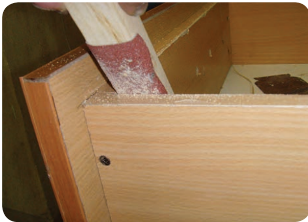
شکل ۵-۱۸۲- برطرف کردن لبه تیز صفحات با سوهان
