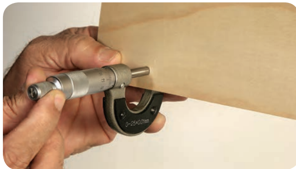
شکل ۷۲-۵- اندازه‌گیری ضخامت روکش با میکرومتر
