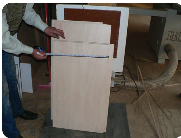
شکل ۱۱۶-۵- کنترل اندازه قطعات آماده شده
