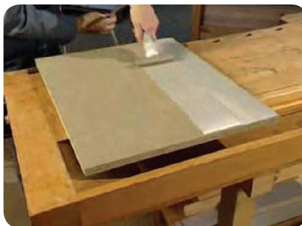
شکل ۹۳-۵- ابزار سرپهن چسب‌زن پنوماتیکی
