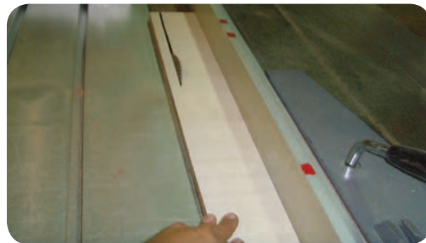
شکل ۱۰۴-۵- خطر پس‌زدن و پرتاب قطعه وجود دارد
