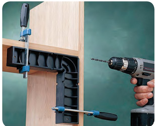
شکل ۱۷۰-۵- استفاده از شابلون برای جلوگیری از دوئیدگی
