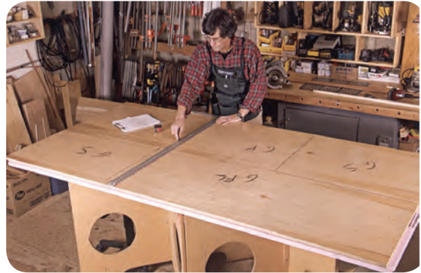
شکل ۵-۴۷- خط‌کشی صفحه‌ام‌دی‌اف برای برش
