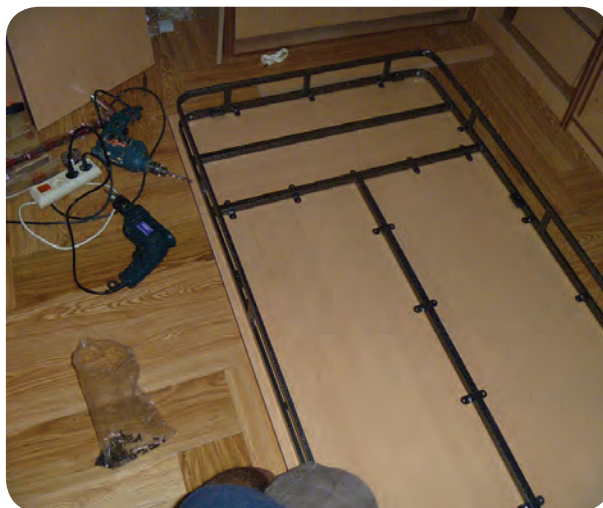
شکل ۱۳۰-۵- استقرار کلاف فلزی روی صفحه جلو تختخواب
