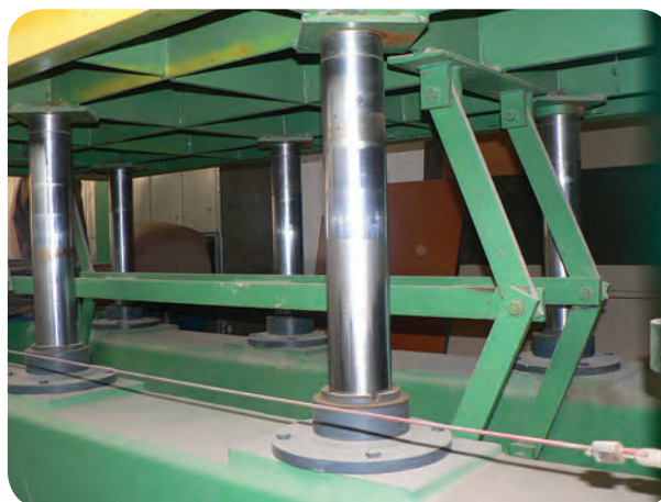
شکل ۸۹-۵- کنترل پیستون و سیلندرهای پرس
