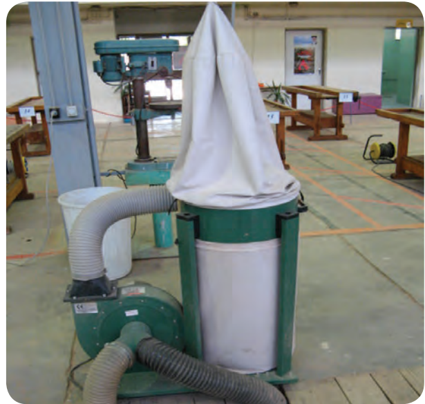
شکل ۵-۲۴- خروج ضایعات از طریق کانال پوشیده شده
