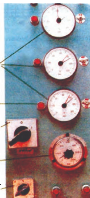
شکل ۸۷-۵- تنظیم اجزای پرس برای چسباندن روکش
