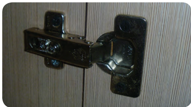
شکل ۵-۱۶۳- نصب لولای گازی فنردار به در کمد
