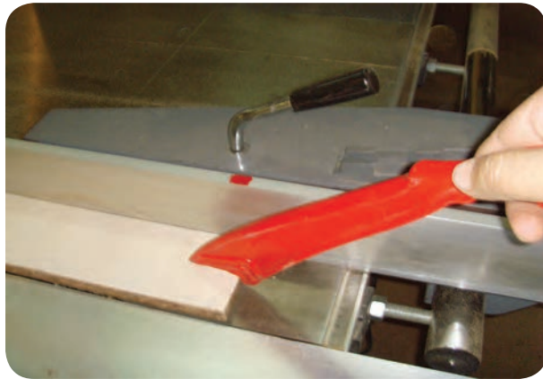
شکل ۵-۶۵- استفاده از وسیله کمکی هدایت قطعه باریک
