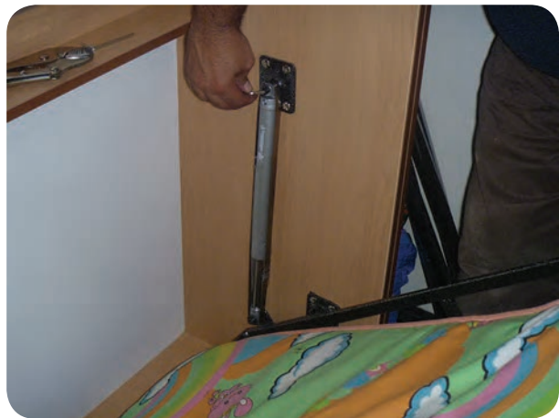
شکل ۵-۱۳۷ تنظیم فشار گاز سیلندر برای تعادل تختخواب
