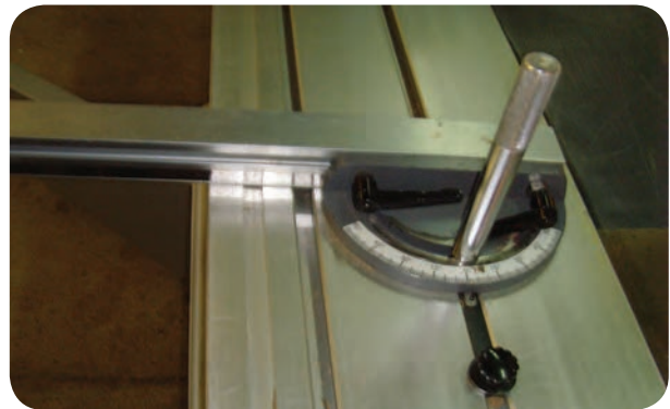
شکل ۵-۵۲- گونیای کوچک قابل تنظیم برای برشکاری
