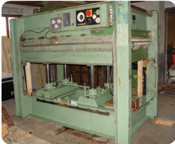
شکل ۷۴-۵- پرس گرم المنتی دو طبقه هیدرولیکی
