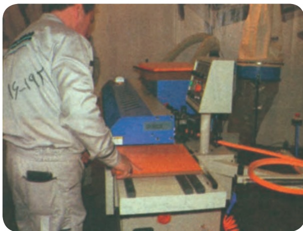
شکل ۱۱۸-۵- نوار چسبانی پی‌وی‌سی با ماشین لبه چسبان
