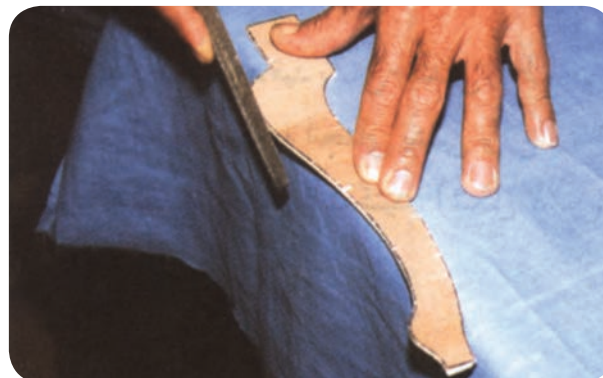
شکل ۵-۲۱- تهیه شابلن خط‌کشی برای ساخت پایه
