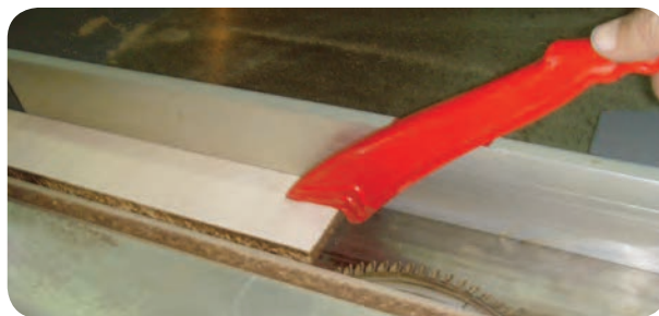
شکل ۵-۲۷- هدایت قطعه باریک در برش توسط وسیله کمکی
