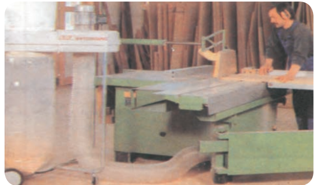
شکل ۵-۲۵- استفاده از حفاظ و تجهیزات ایمنی
