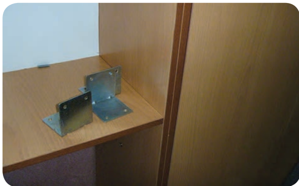
شکل ۵-۱۱۰- بدنه‌های مقرر تخت خواب از دو ام‌دی اف ۱۶ میلی‌متری
