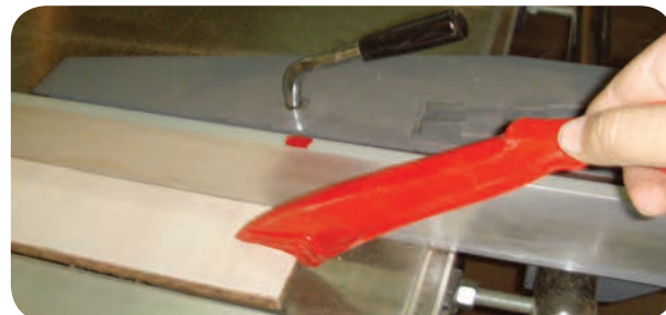
شکل ۱۰۵-۵- هدایت قطعه باریک به وسیله کمکی
