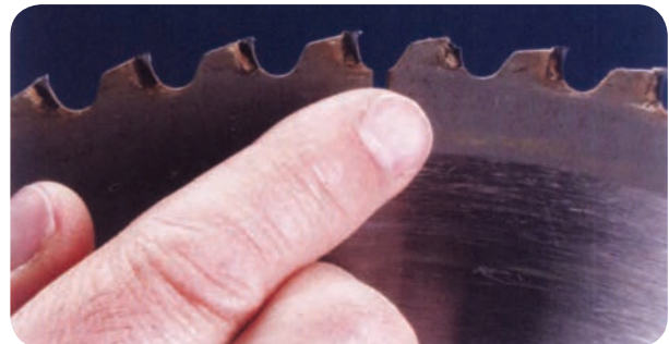
شکل ۵-۴۲ دندان‌های اره شکسته یا کند شده
