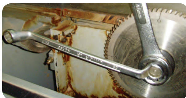
شکل ۵-۵۶- نحوه باز و بسته کردن تیغه اره
