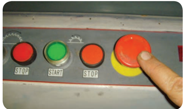
شکل ۵-۶۷- کلید خاموش کردن کلی ماشین دور کن
