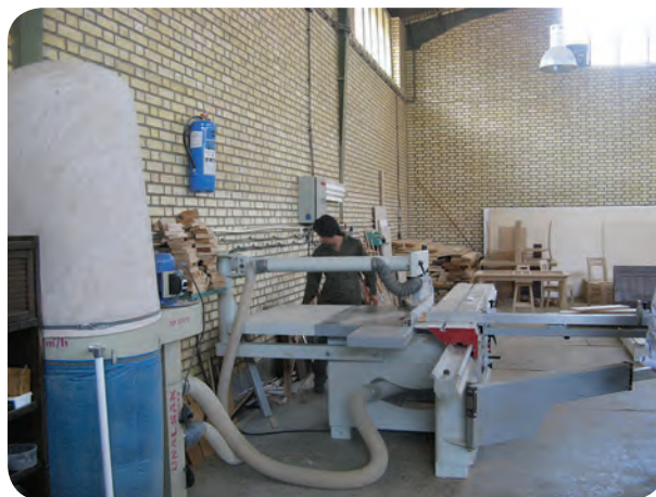
شکل ۵-۵۹- مکنده مناسب ماشین دورکن
