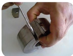
شکل ۲۷-۲- تنظیم و محکم کردن تیغه داخل تویی
