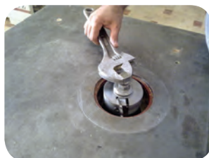
شکل ۲۸-۲- تنظیم کردن تویی در دستگاه فرز
