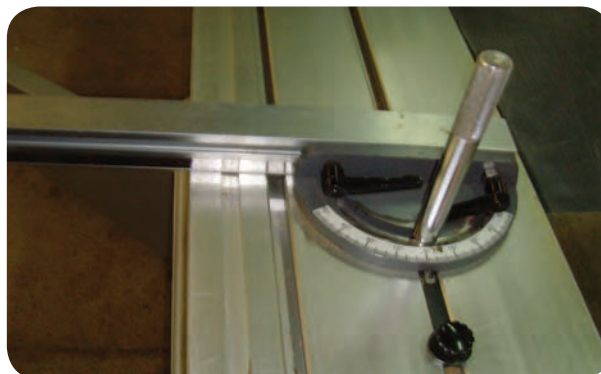
شکل ۵۲-۵ گونیای کوچک قابل تنظیم برای برشکاری
