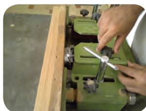
شکل ۲۹-۲- الف - بستن حفاظ‌ها
