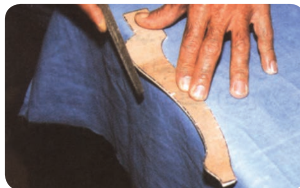
شکل ۵-۲۱ تهیه شابلن خط‌کشی برای ساخت پایه
