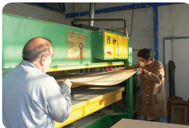
شکل ۵-۹۶- خارج کردن صفحات پرس شده
