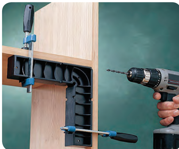
شکل ۱۷۰-۵- استفاده از شابلون برای جلوگیری از دوئیدگی
