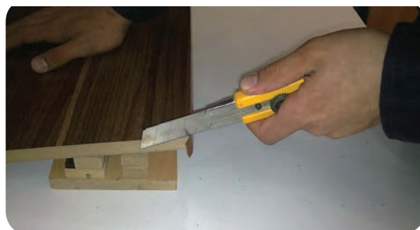
شکل ۴-۲۸ - قطع کردن سرو ته نوار با کاتر
