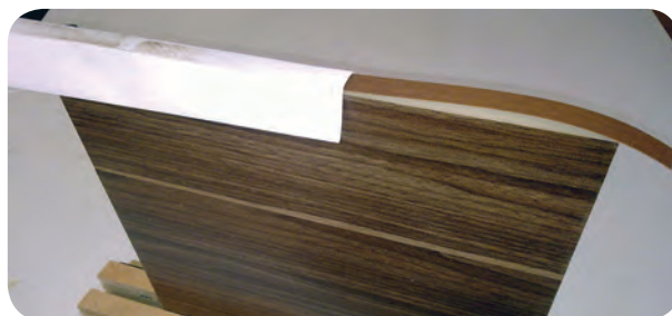
شکل ۴-۱۴ - نحوه استفاده از کاغذ در زیر اتو
