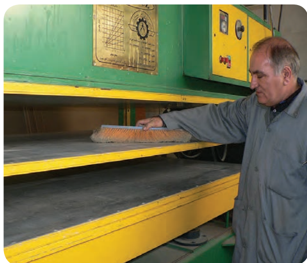
شکل ۵-۹۸- تمیز کردن پرس در پایان کار
