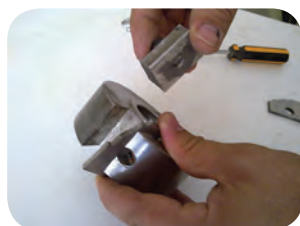
شکل ۲۷-۲- تنظیم و محکم کردن تیغه داخل تویی
