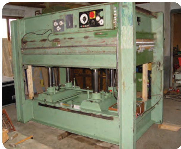
شکل ۷۴-۵ پرس گرم المنتی دو طبقه هیدرولیکی
