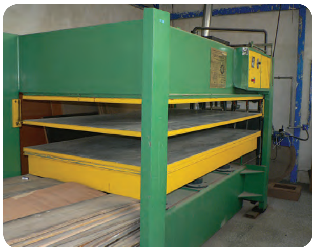
شکل ۷۵-۵ پرس سه طبقه روغنی هیدرولیک گرم
