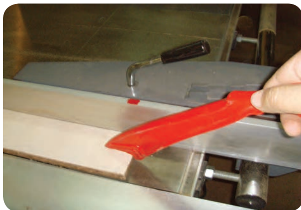
شکل ۵-۶۵- استفاده از وسیله کمکی هدایت قطعه باریک
