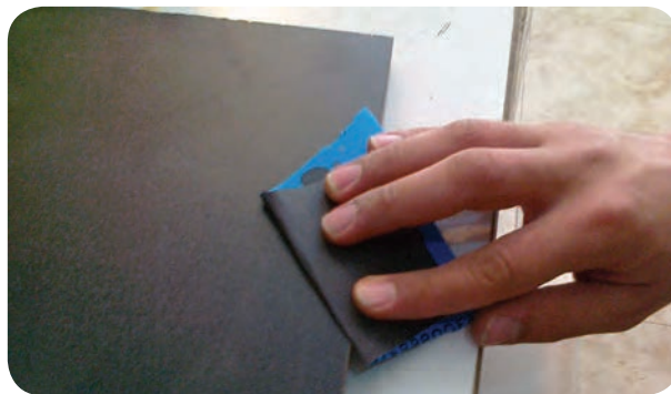
شکل ۴-۳۰ - پرداخت لبه لبه‌های نوار شده با سنباده
