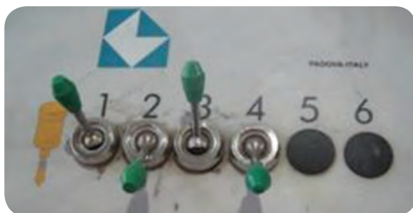
شکل ۳-۶ - کلیدهای بالا و پایین برنده جک‌ها
