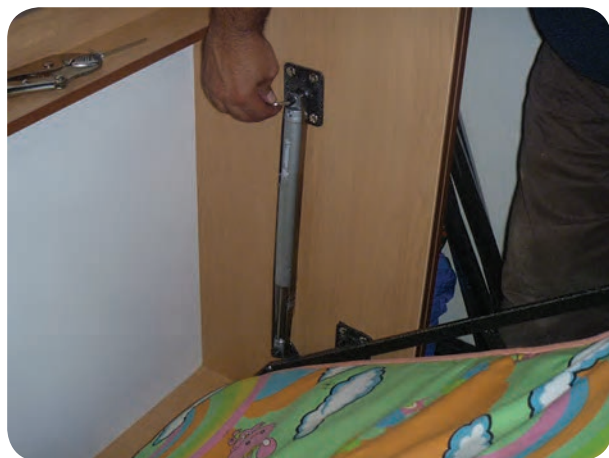
شکل ۵-۱۳۷ تنظیم فشار گاز سیلندر برای تعادل تختخواب
