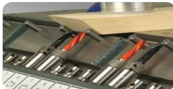
شکل ۳-۵ - سوراخ کاری قطعات زاویه دار
