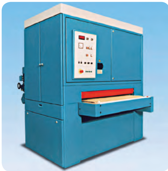
شکل ۷۳-۵ ماشین سنباده نوار غلتکی عمودی
