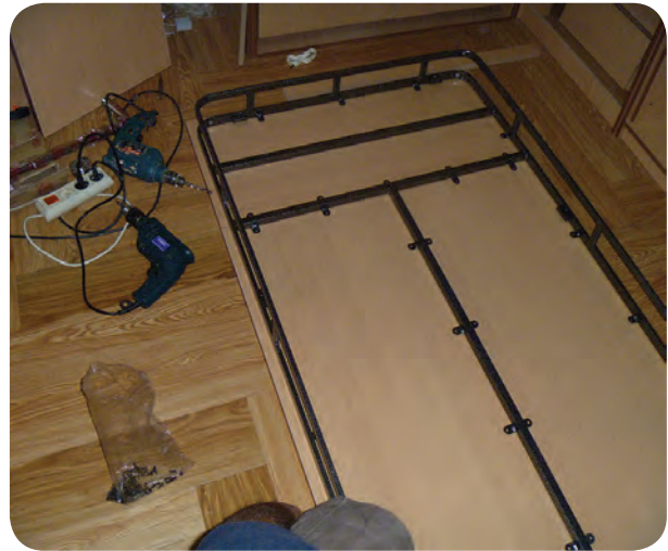
شکل ۱۳۰-۵- استقرار کلاف فلزی روی صفحه جلو تختخواب
