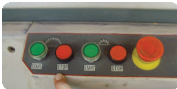
شکل ۵-۶۰- کلید خاموش و روشن کردن ماشین دورکن
