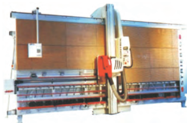
شکل ۳۶-۵- اره صفحه بر یا پانل بر اتوماتیک
