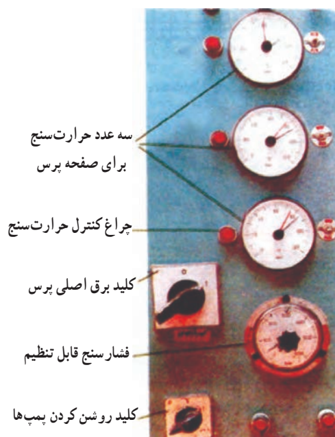
شکل ۸۷-۵- تنظیم اجزای پرس برای چسباندن روکش
