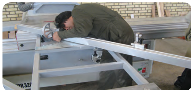
شکل ۵۰-۵- تنظیم دو کفشک کنترل اندازه گیری
