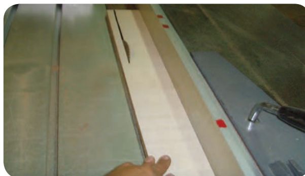
شکل ۵-۱۰۴- خطر پس‌زدن و پرتاب قطعه وجود دارد
