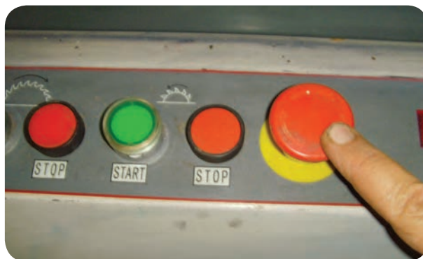
شکل ۵-۶۷- کلید خاموش کردن کلی ماشین دور کن
