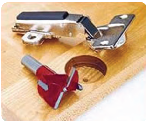
شکل ۱۴۹-۵- ایجاد جای لولای گازی در جوب به وسیله متۀ مخصوص
