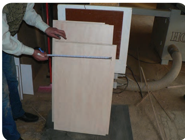
شکل ۵-۱۱۶- کنترل اندازه قطعات آماده شده
