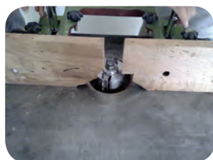
شکل ۲۹-۲- الف - بستن حفاظ‌ها
