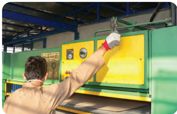
شکل ۹۵-۵- اهرم باز کردن صفحات پرس
