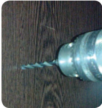
شکل ۱-۶- سوراخکاری دکور با مته چوب یا آهن
