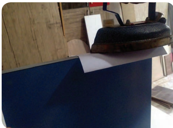
شکل ۴۸- حرکت اتو در روی قطعه کار
