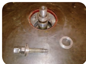
شکل ۲۸-۲- تنظیم کردن تویی در دستگاه فرز
