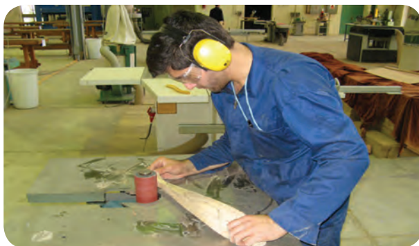
شکل ۲۶-۵- استفاده از وسایل ایمنی در موقع کار
