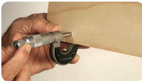
شکل ۷۲-۵ اندازه‌گیری ضخامت روکش با میکرومتر
