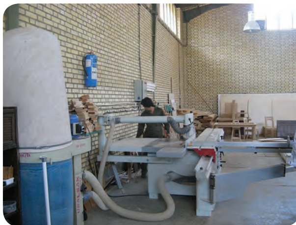
شکل ۵-۵۹- مکنده مناسب ماشین دورکن
