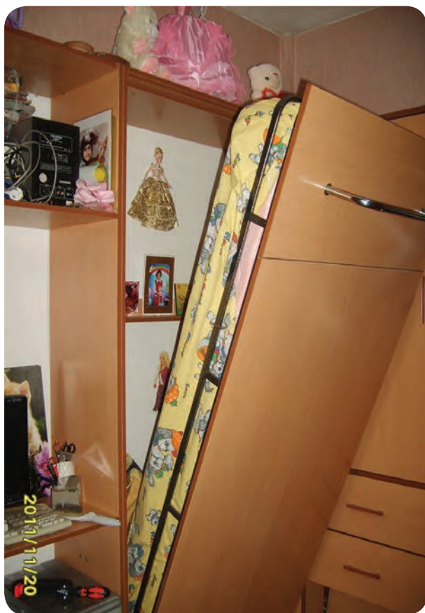
شکل ۱۸۴-۵ کنترل تعادل تختخواب به وسیله جک‌ها
