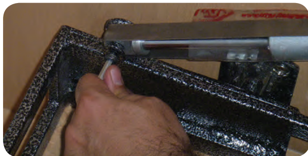
شکل ۵-۱۳۶ محکم کردن پایه‌های جک‌های تختخواب
