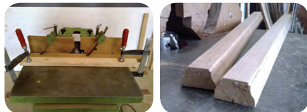
شکل ۲-۳۰- چوب ابزار خورده، ابزار زدن قطعه کار
