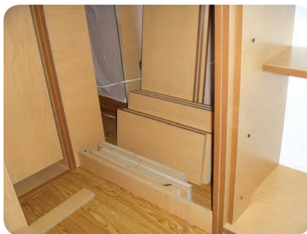
شکل ۱۱۱-۵- قطعات آماده و عمق کمد لباس و کسوها
