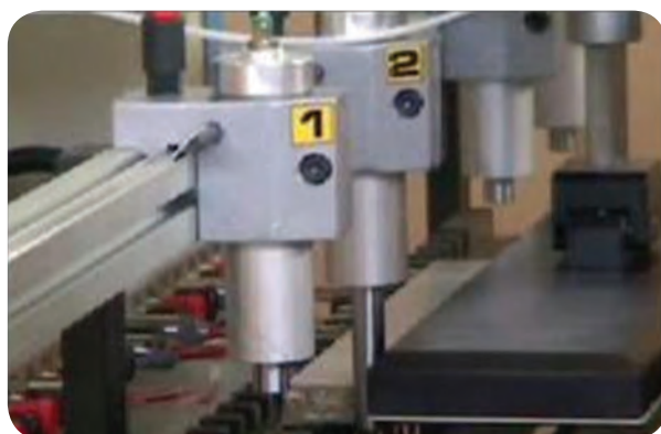
شکل ۳-۷ - قطعه کار، توسط جک‌ها گونیا شده است.
