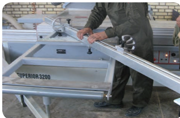
شکل ۵۱-۵ تنظیم گونیا با تکیه‌گاه برای برش کج صفحات
