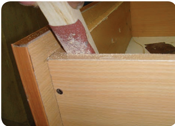
شکل ۵-۱۸۲- برطرف کردن لبهٔ تیز صفحات با سوهان
