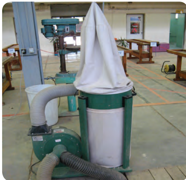
شکل ۲۴-۵- خروج ضایعات از طریق کانال پوشیده شده
