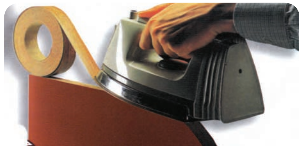
شکل ۴-۱۶ - نوار کردن لبه‌های قوس‌دار توسط اتو
