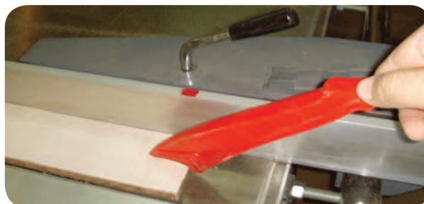
شکل ۵-۱۰۵- هدایت قطعه باریک به وسیله کمکی
