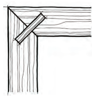
شکل (۵-۱۰۶) ترسیم اتصال گوشه‌ای قلیف فارسی با زبانه جدا (زبانه از جنس‌های مختلف)
