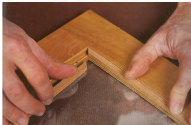
شکل (۵-۴۱) تصویر مجسم انفجاری اتصال گوشه قاب و اتصال آن
