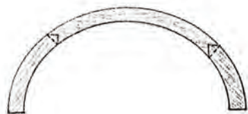
شکل (۱۳۴-۳) اتصال طولی قطعات قوس دار
