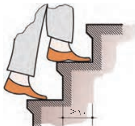
شکل ۱۶-۳ کوچک‌ترین اندازه‌ی کف پله در پله‌های پیچ
