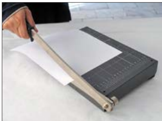
شکل ۱-۵۱ برش کاغذ با گیوتین
