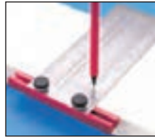
شکل ۱-۳۴ قرقره‌های متصل کننده‌ی خط کش به میز
