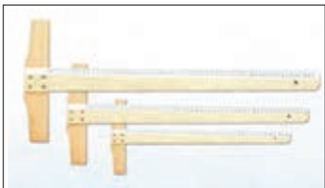
شکل ۱-۳۰ خط کش تی چوبی با سر ثابت
